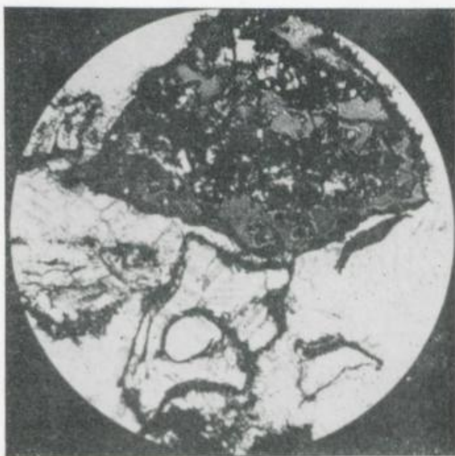
Bild 24. Calcit-„Chamosit“-Erz („chloritisches Scheckenerz“). Chamositbrocken mit Magnetitneubildung; die beiden kleineren „Lapilli“ vollständig calcitiert, Grundmasse Calcit
