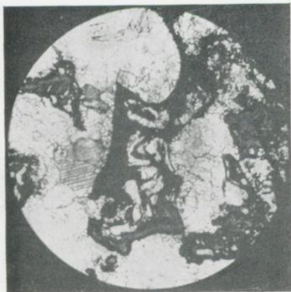
Bild 27. Calcit-„Chamosit“-Erz („chloritisches Scheckenerz“). Erzpartikel mit Lapillistruktur, pseudomorphosiert durch Calcit, grünes Eisensilikat („Chamosit“) und randlich Magnetit
