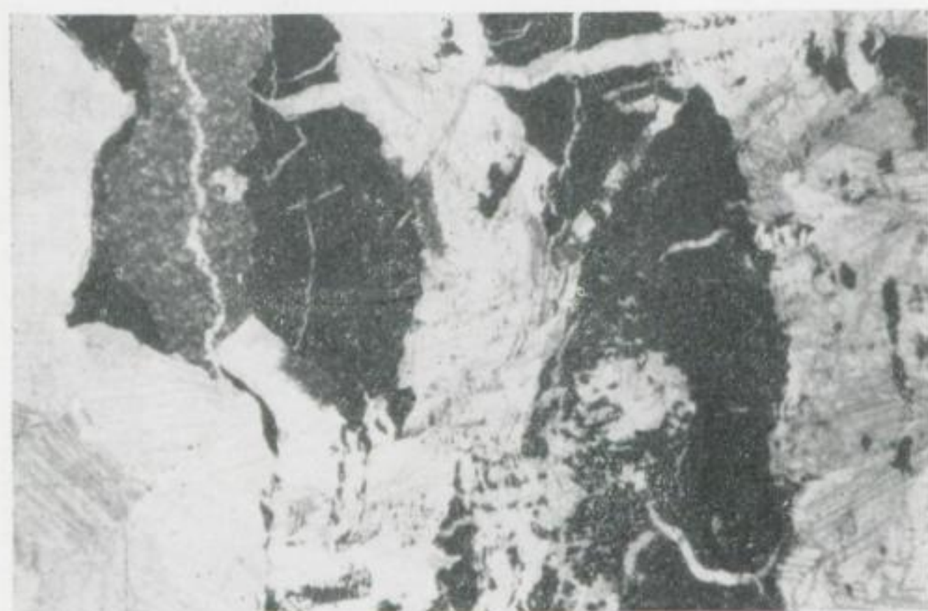
Bild 26. Auseinanderdriften eines Eisenoxydbröckchens, eingelagert in calcitischer Grundmasse (sog. „Scheckenerz“). Auf Kluft Neubildung von Chamosit (graufleckig)
