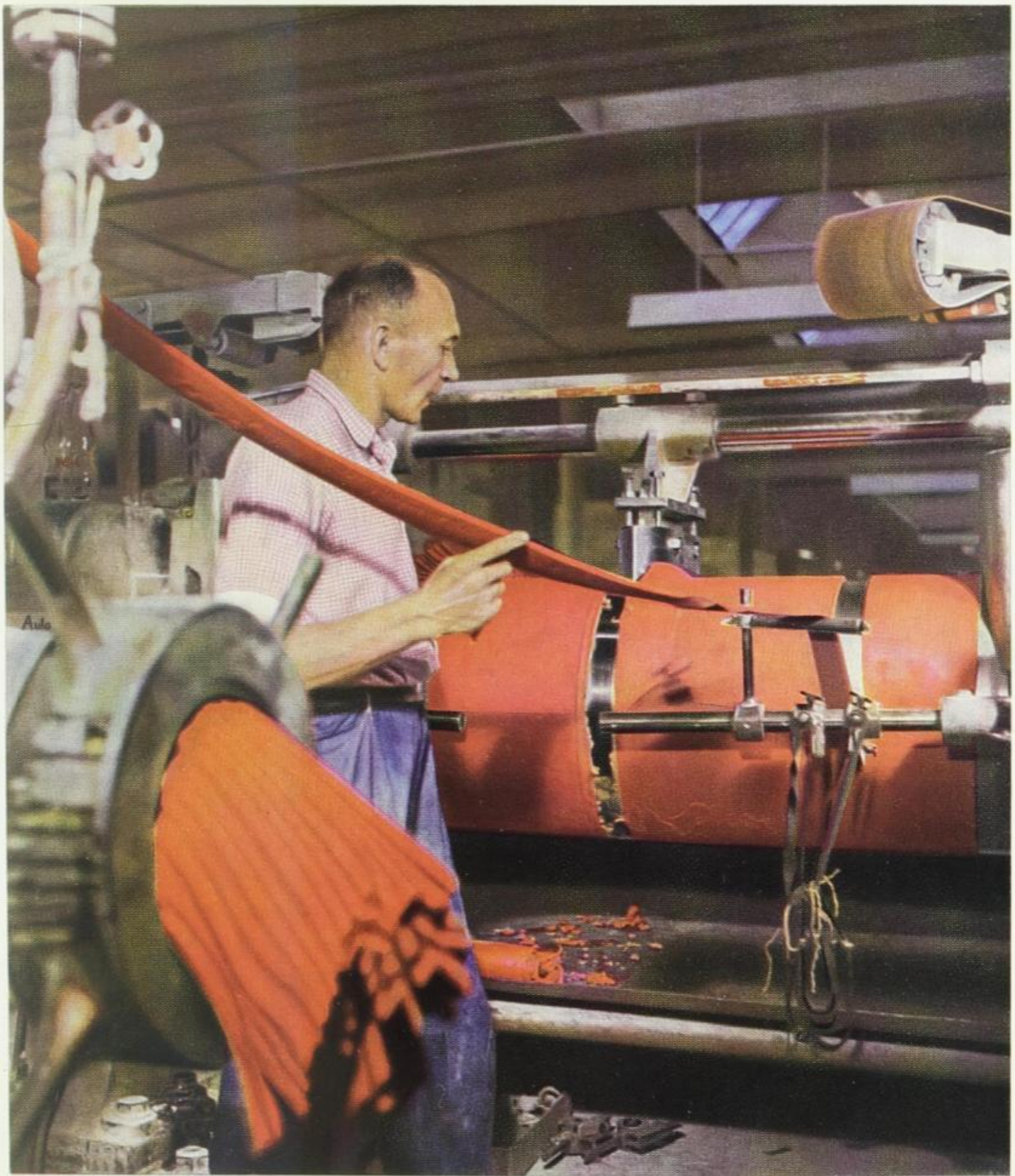
Vorwärmen und Strainern von Luftschlauch-Mischungen.
