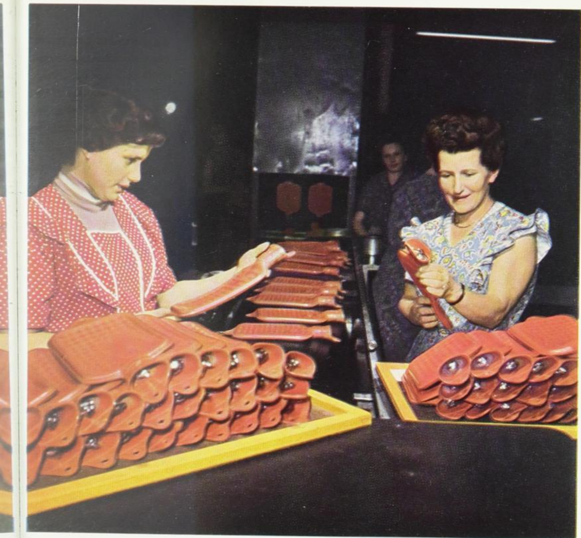
Wärmflaschen werden vor der Verpackung einer letzten Fehlerkontrolle unterzogen.
