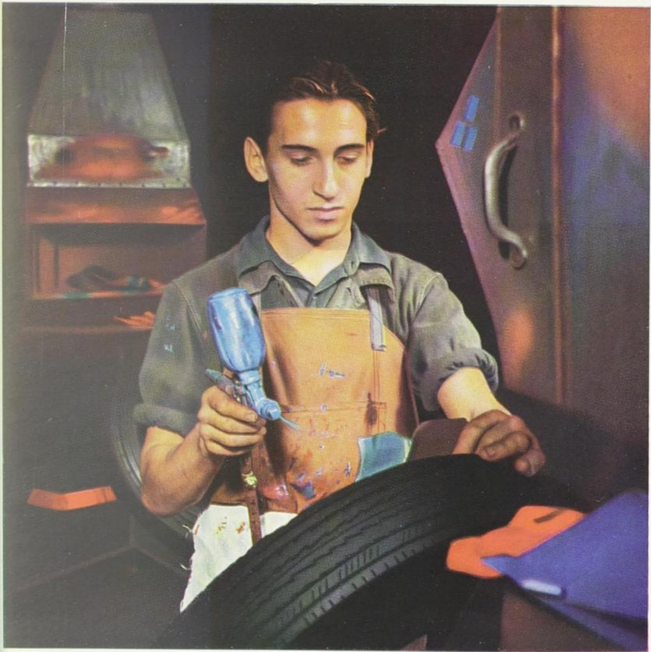
Mit der Farbspritzpistole und einer Schablone wird auf den Autoreifen das blau-rote Phoenix-Gütezeichen aufgebracht.
