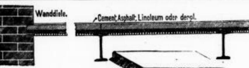
**Zementdielen** für Decken, Wände, Isolierungen
