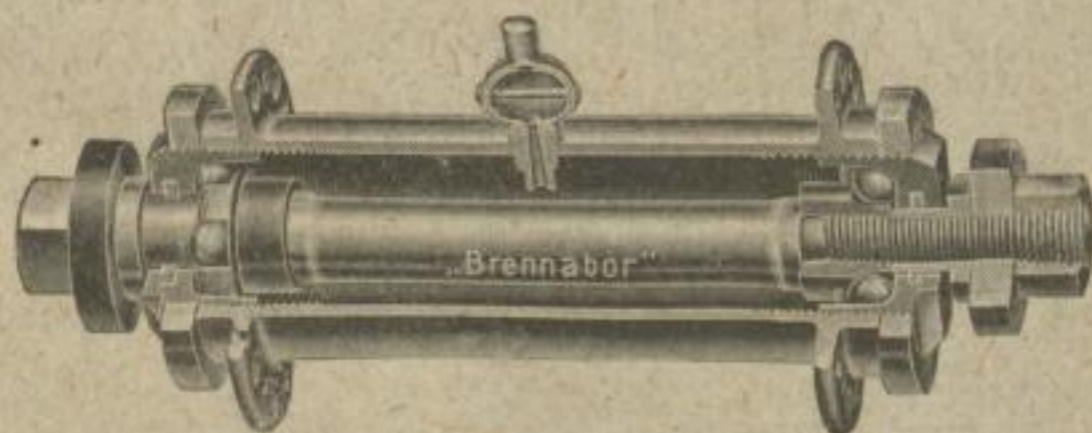
Vorderradnabe im Durchschnitt.
