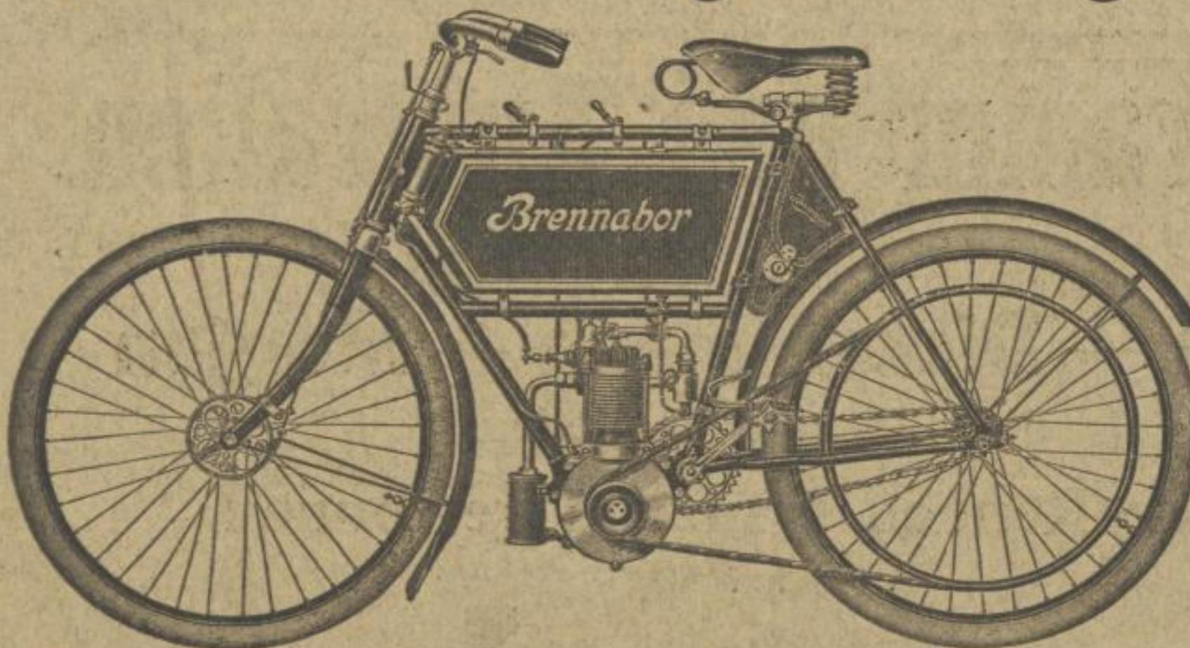
Zuverlässiger, starker Rahmenbau, sicher wirkende Vorderrad-Bandbremse, senkrecht stehender, im Rahmen eingebauter Motor, daher minimale Abnutzung des Cylinders und gleichmäßige Ölung, handlich angebrachte und während der Fahrt leicht zu benutzende Ölspülung, Drosselhahn u. trotzdem nur 2 Hebel, neuer, automatischer Vergaser, extra starke 2<sup>o</sup> Motorreifen u. Felgen, besonders kräftiger u. breiter Motorsattel.
