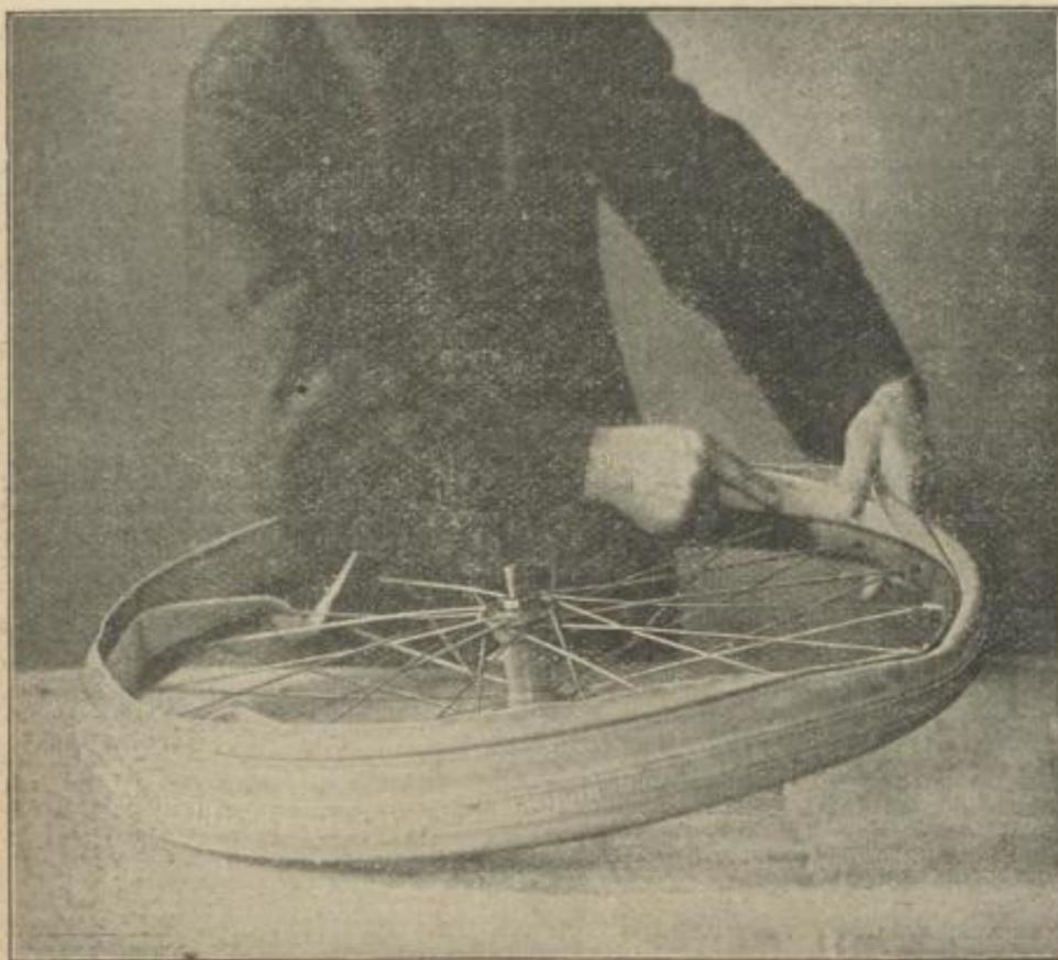
5. Einlegen des Schlauches. Man beginnt beim Ventil und achtet darauf, daß der Schlauch faltenlos und gerade in die Decke kommt. Nun ist der zweite Wulst zu montieren.
