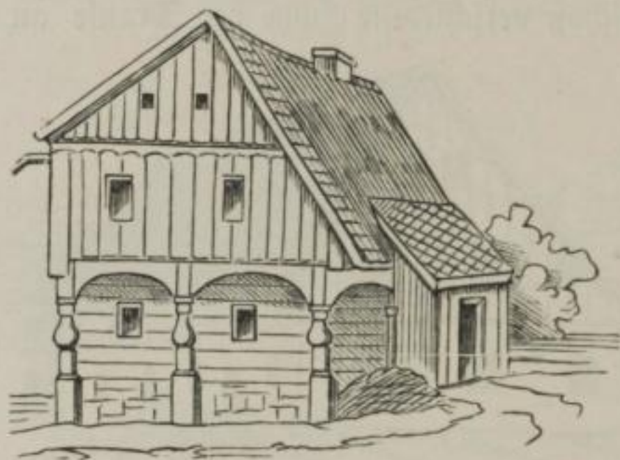
Fig. 171. Thomasdorf. Einhüftiges Haus mit ungleicher Dachneigung.
