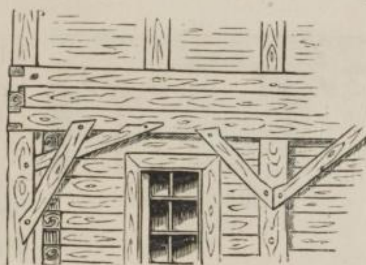
Fig. 204. Lohmen. Kopfbänder des Umgebendes.
