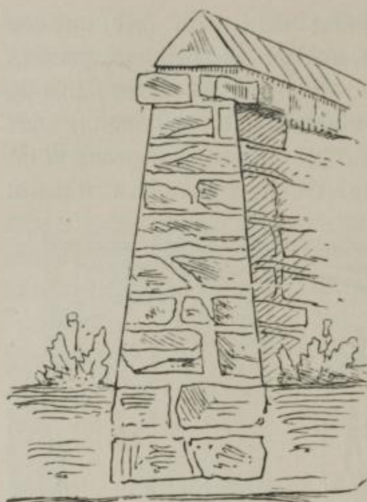
Fig. 181. Plänermauer im Querschnitt.
