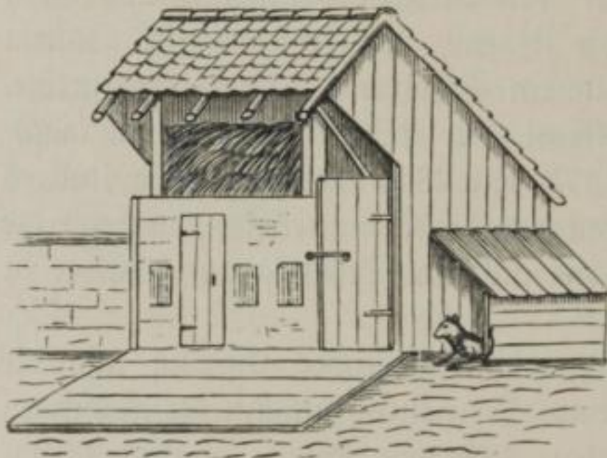
Fig. 196. Medingen. Schweineestall mit Futterboden, Abort und Hundehütte, davor die Jauchengrube.
