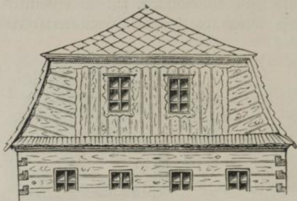
Fig. 191. Tanndorf. Brettgiebel mit Schiefer-Krüppelwalm; Wetterdach mit Schindeln.
