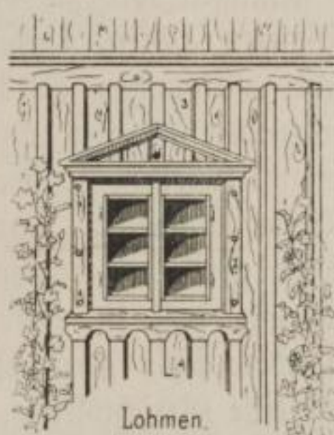
Fig. 212. Fensterumrahmung auf Brettverschalung.
