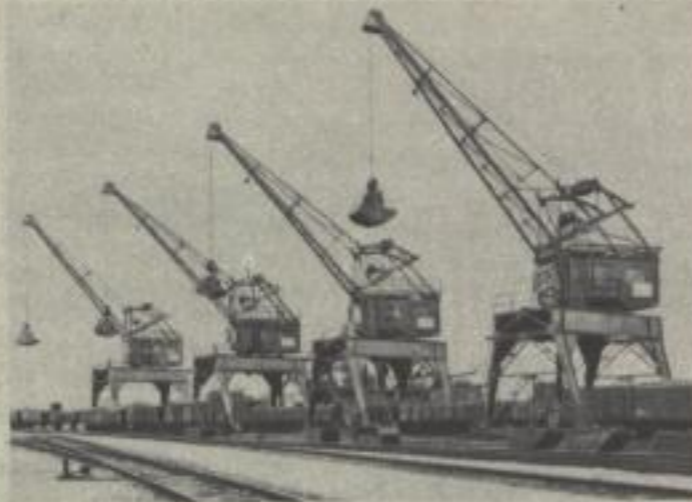
Kampnagel Greifer-Wipkranne Stönt Tragfähigkeit im Hafen von Danzig
