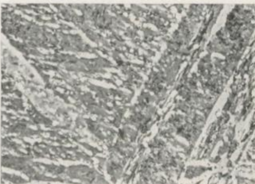
Bilder 46 bis 49. Stahl K 50 bei verschiedenen Anlaßtemperaturen und Haltezeiten
