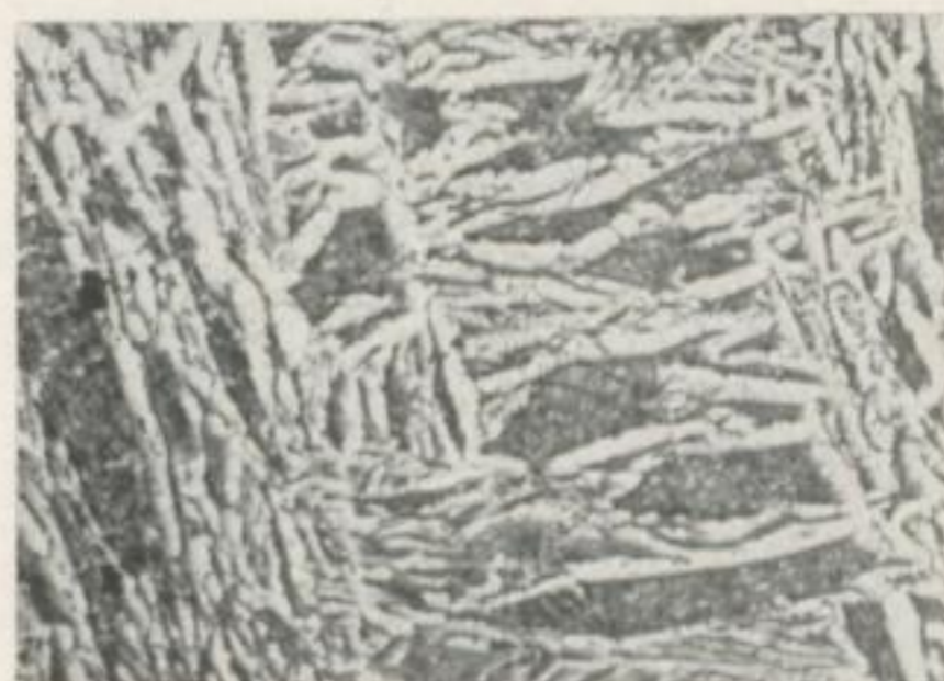
Bilder 30 bis 33. Stahl K 50 bei verschiedenen Anlaßtemperaturen und Haltezeiten
