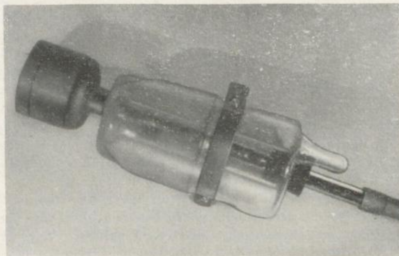
Bild 13. Elektromagnetische Halterung für scheibenförmige Stahlproben
