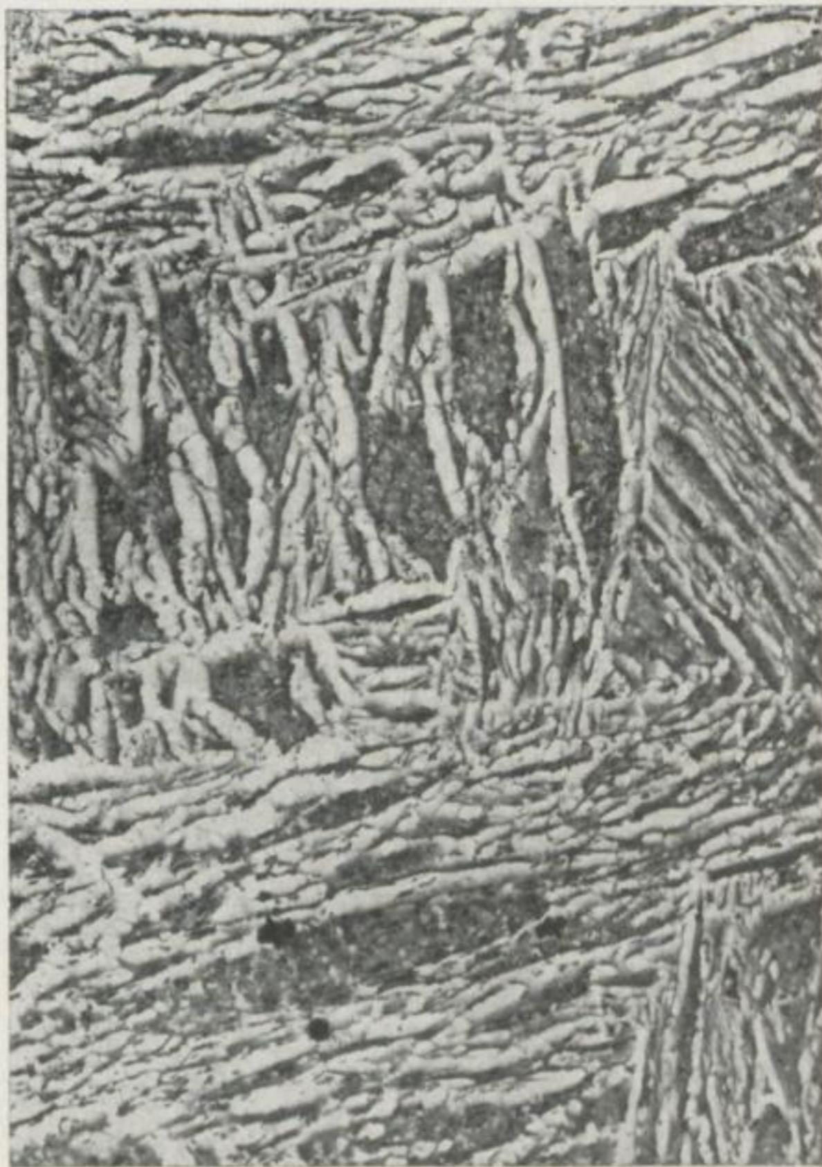
Bild 59. „Kombinierter Relief-/Ausziehabdruck“, Stahl K 50, 30 min, 1150 °C/Wasser/ 500 min, 200 °C/Luft, 5000 : 1
