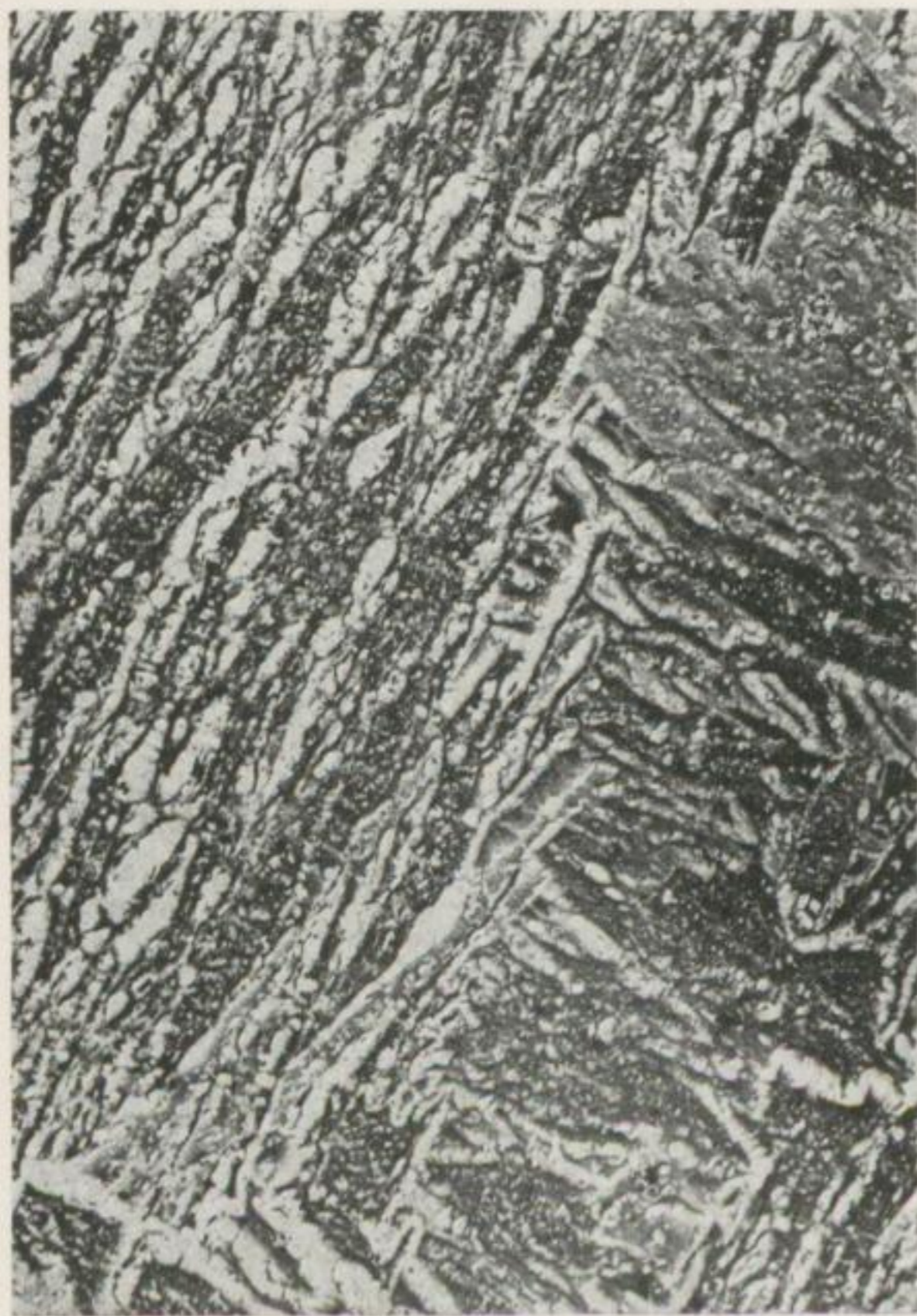
Bild 60. „Kombinierter Relief- Ausziehdruck“, Stahl K 50, 30 m, 1150 °C Wasser/ 500 min, 300 °C Luft, 5000 : 1
