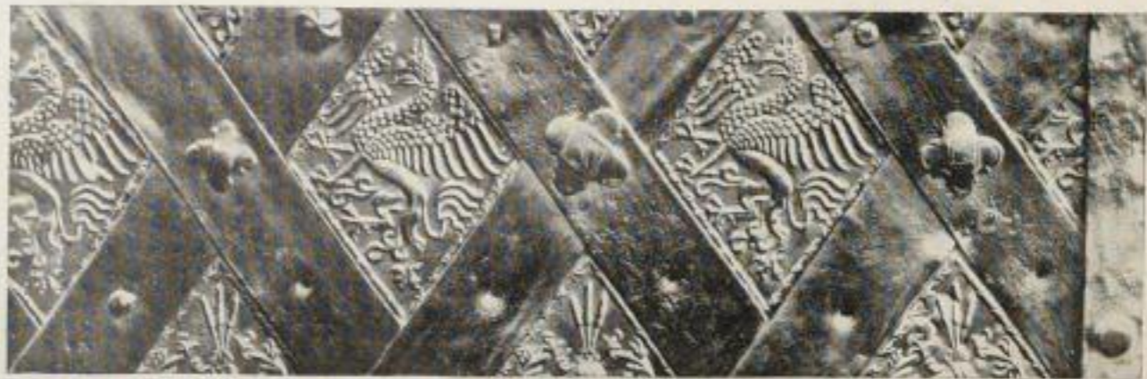
Drücken ins Gesenk mit Hilfe einer Bleiplatte auf einer Zink- oder Stahlmatrize.
