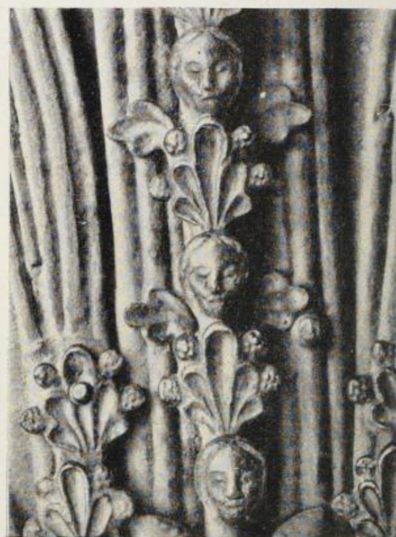
Im Gesenk geschmiedete und zusammengeschweißte Eisenarbeiten.
