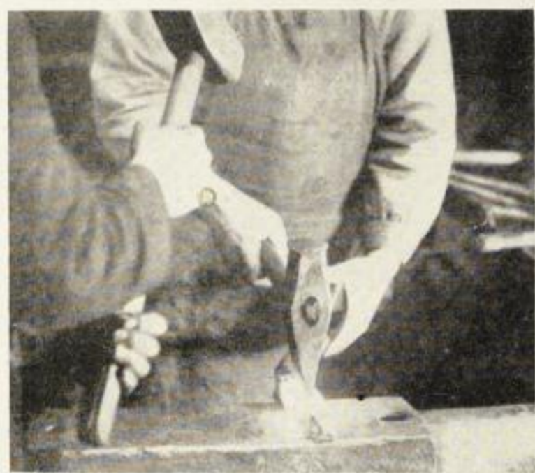
Darstellung des „Verdrehens“ oder „Torsierens“ sowie des „Aufspaltens“ (unten).
