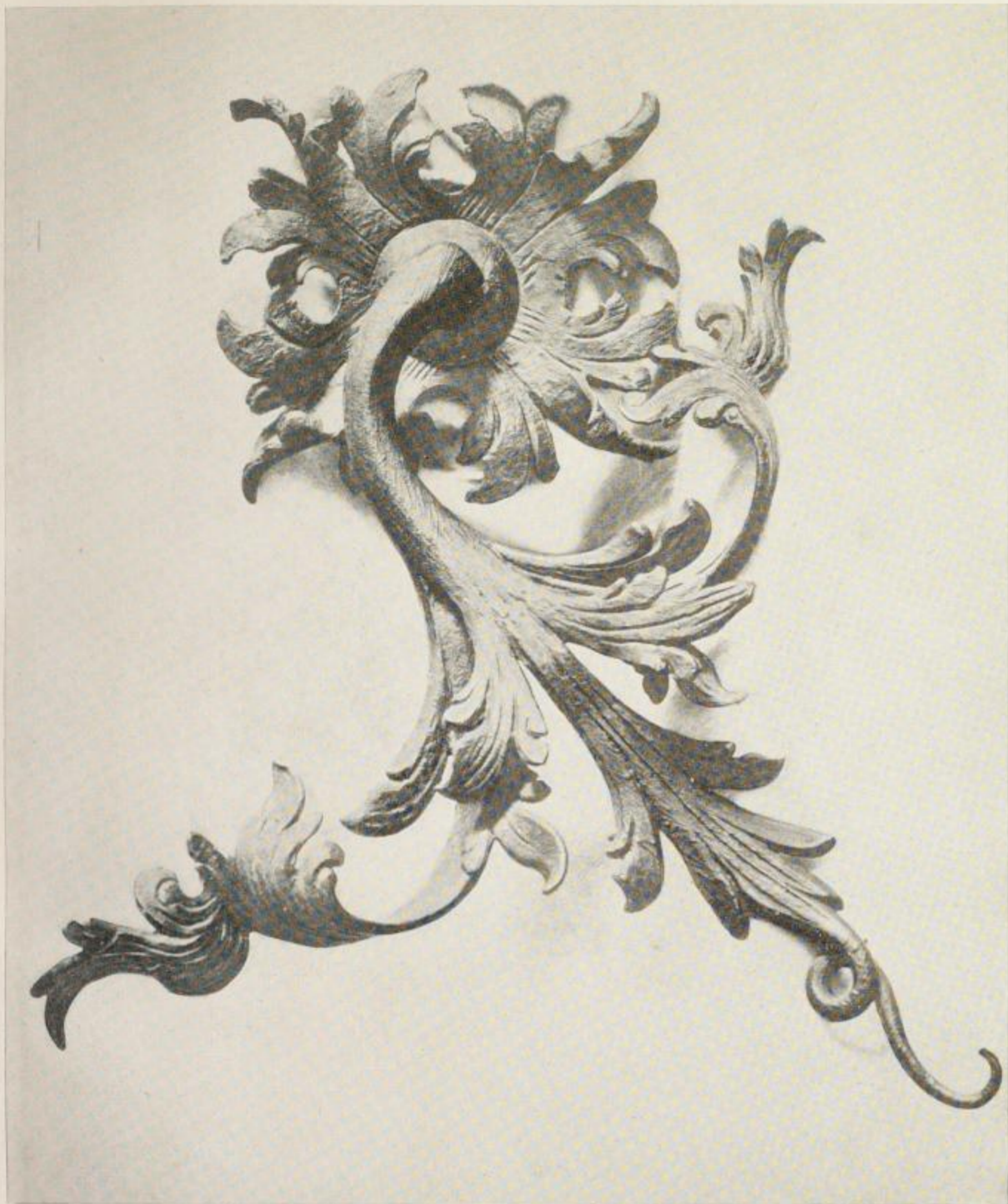
Durch Spalten, Strecken, Breitziehen und Kehlen geformte Werkstücke.
