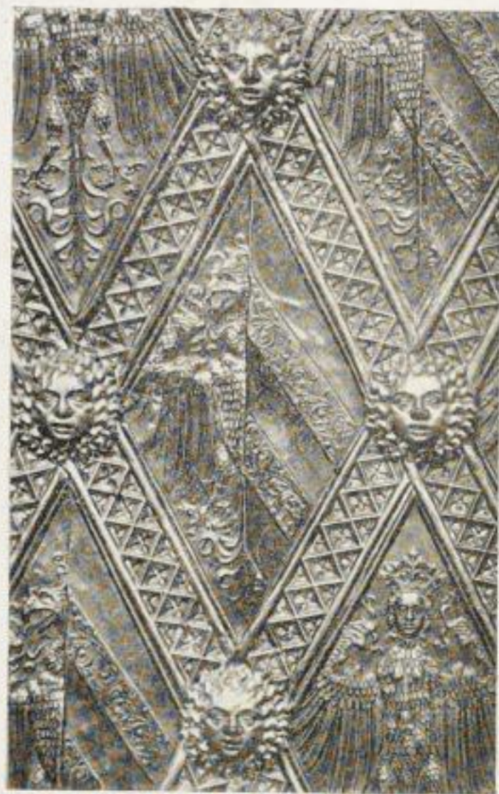
Ins Gesenk gedrückte Eisenplatten. Unten rechts ins Gesenk gedrückte Silberplatte.
