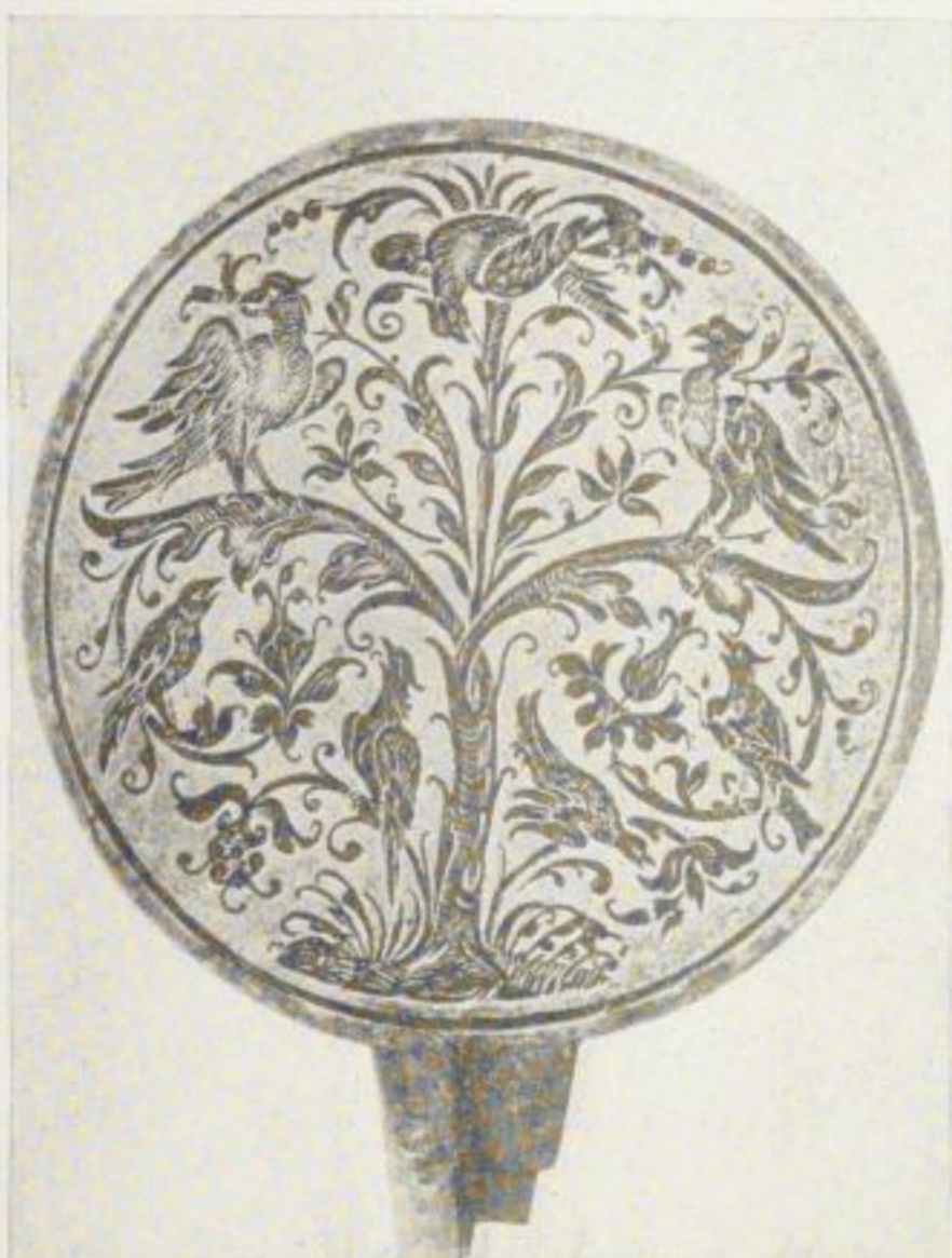
Hostienseisen. Formung erzielt bei 1 u. 3 mit Eisenschnitt, bei 2 durch Ein- hauen mit Punzen, bei 4 durch Ätzen.
