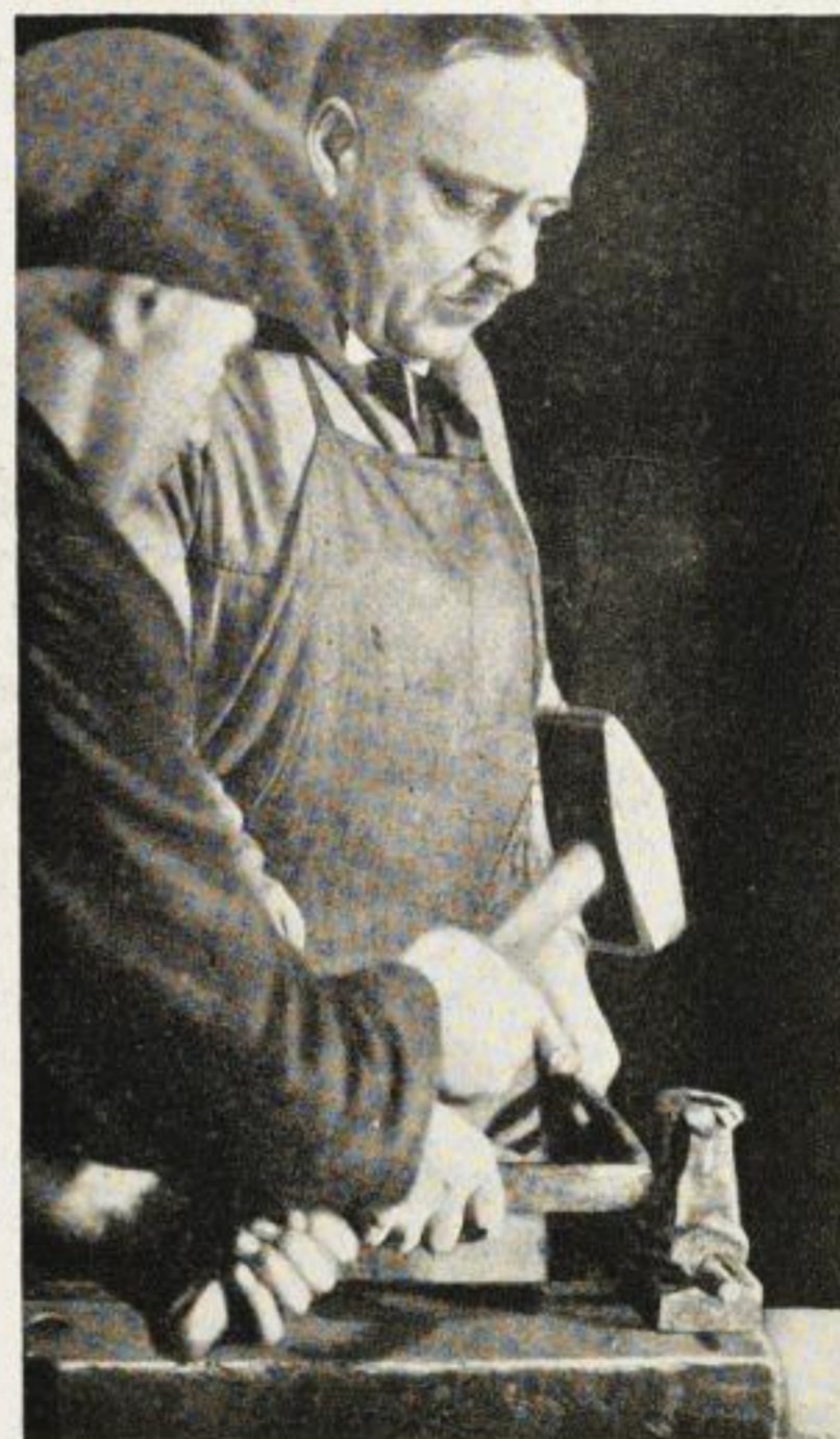
Darstellung des Stauchens eines Rundstabes und Schmiedens im Gesenk. Im Gesenk geschmiedeter Baluster (vgl. Tafel 24).
