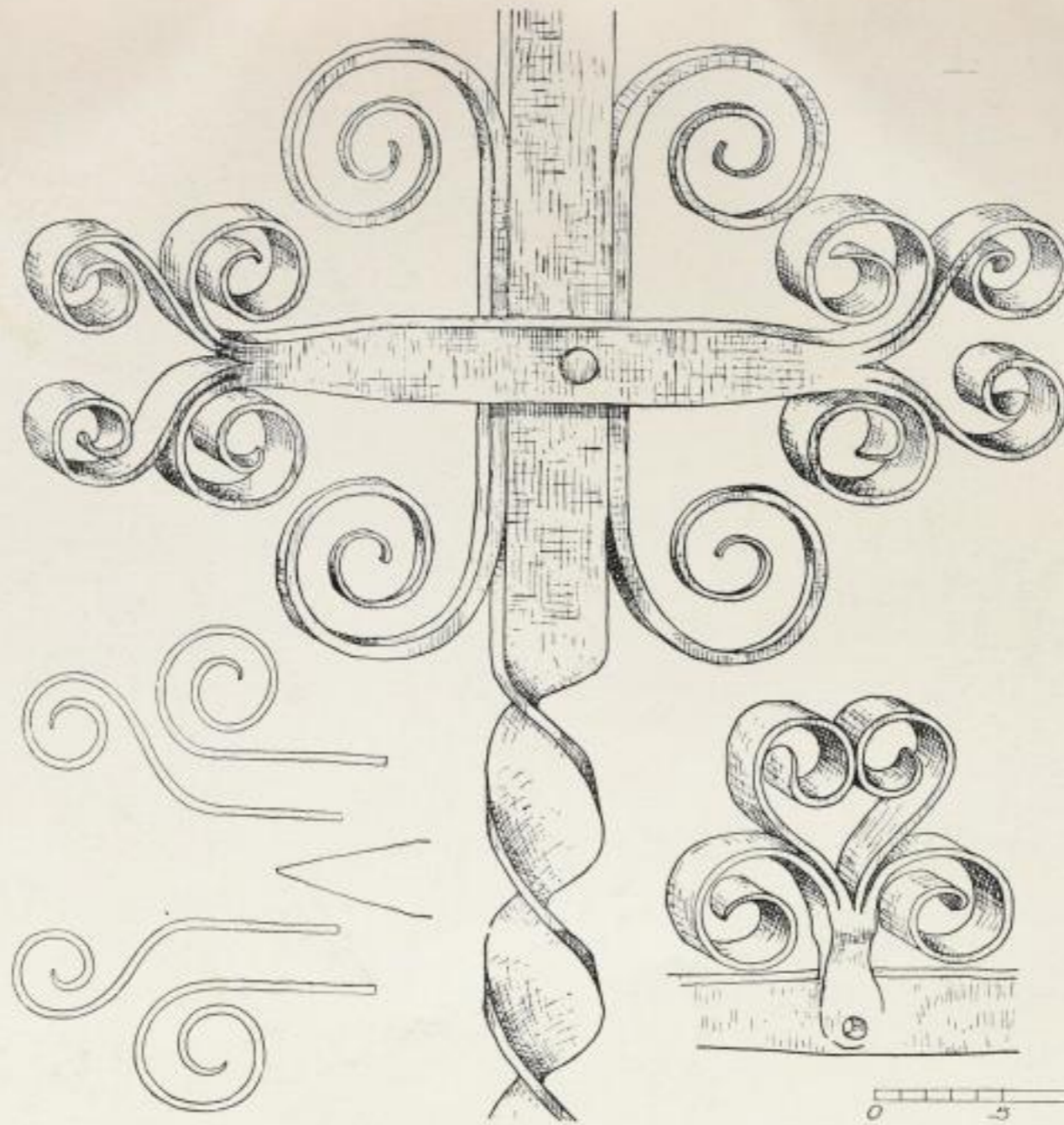
Grabkreuze aus Schmiedeeisen mit Darstellung der verschweißten Einzelheiten.
