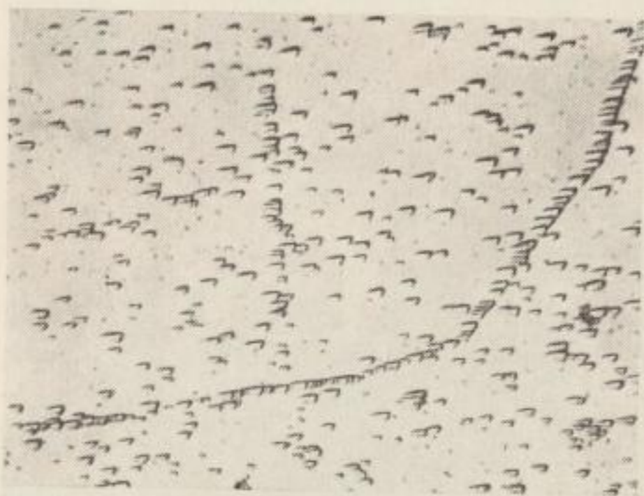
Bild 27 Molybdän, elektronenzonengeschmolzen, nach einem Durchgang, einkristallin, Orientierung um (321), Subkorn Grenzen. Chemisch geätzt mit 10%iger KOH und 10%iger K_3Fe(CN)_6 V = 300 : 1
