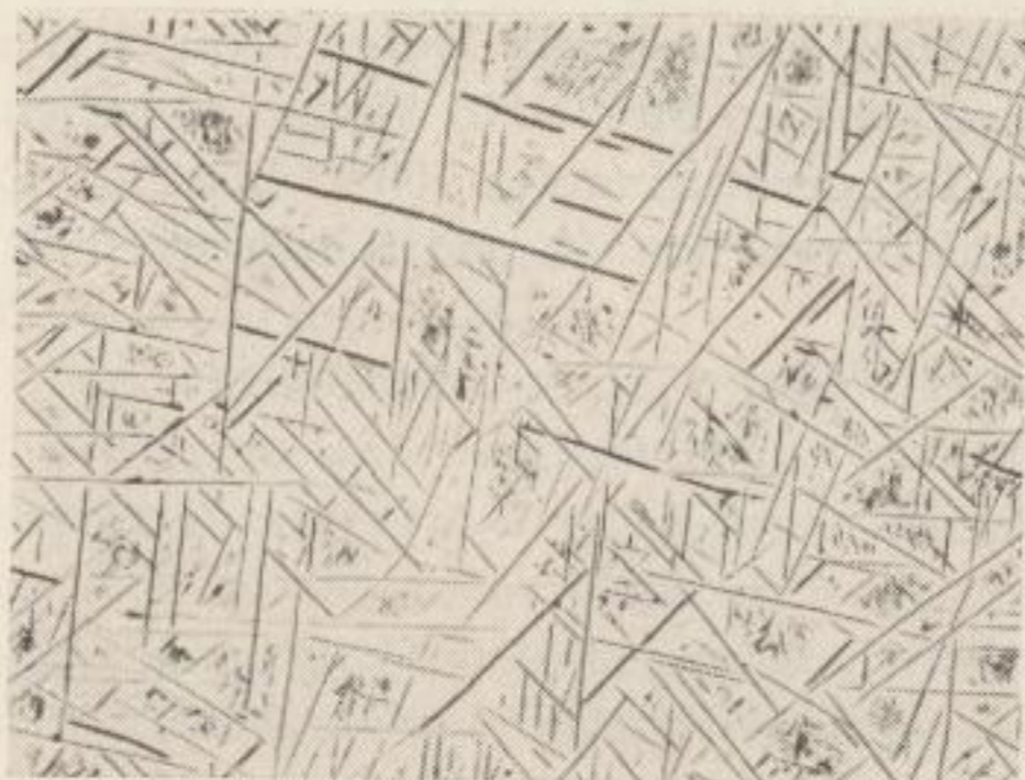
Bild 30 \gamma' -Fe 4 N- und \alpha'' -Fe 16 N 2 -Ausscheidungen in einem \alpha -Eisenkristall. Geätzt mit 3%iger HNO 3 . V = 120 : 1
