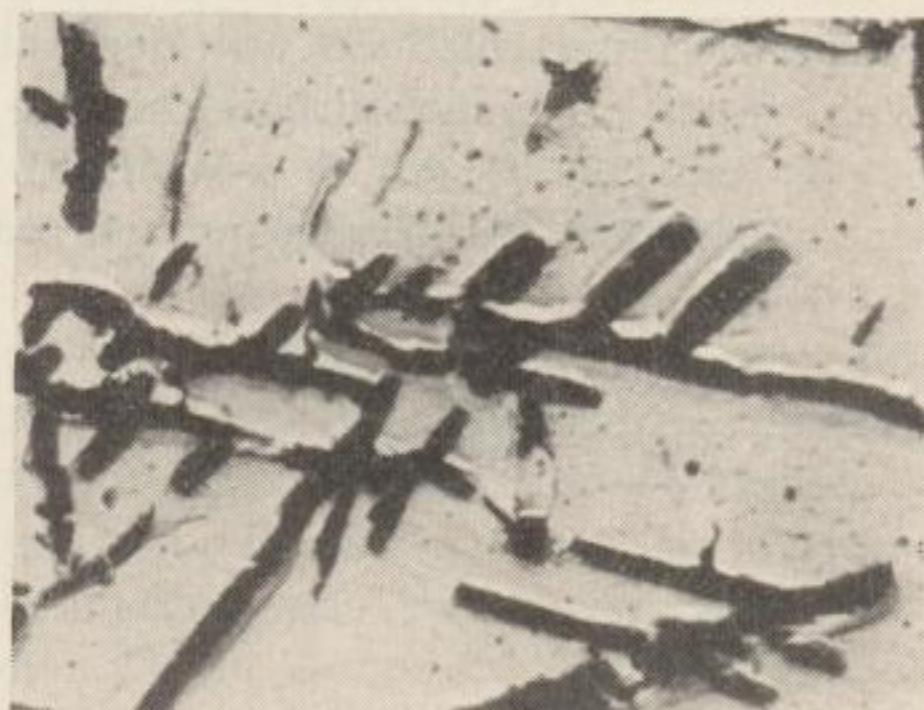
Bild 31 \alpha'' -Fe 16 N 2 -Ausscheidungen zwischen grö- ßeren \gamma' -Fe 4 N-Kristallen in \alpha -Eisen. Elektronenmikroskopische Aufnahme: D. Schulze. Extraktions-Replika. V = 2400 : 1
