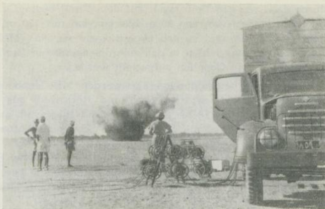
Bild 20. Schuß mit Ladung 1,5 kg, schwach verdammt (Photo: RISCHE)
