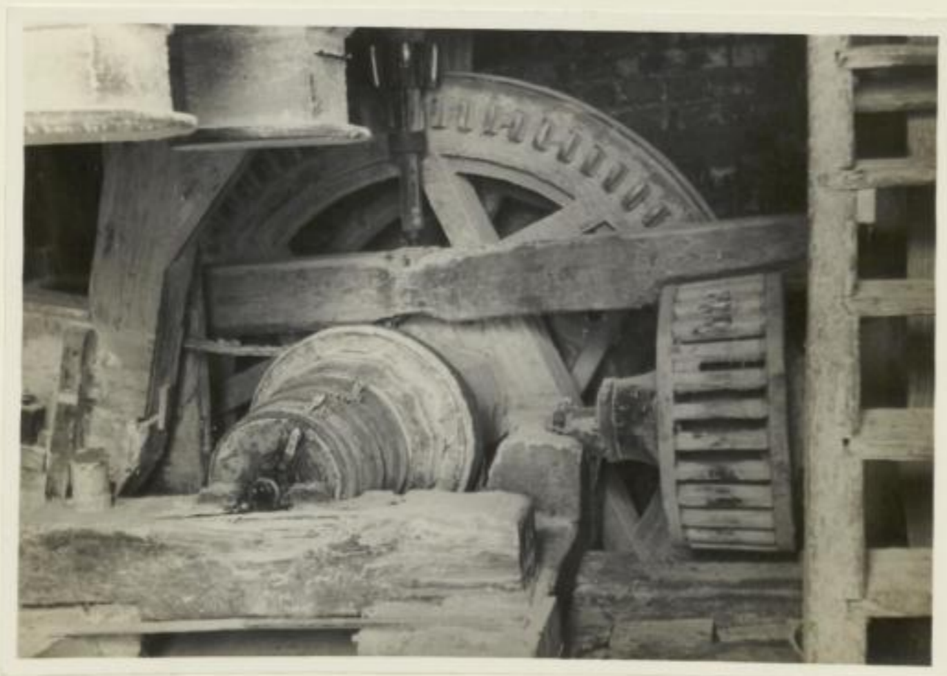
Abb. 22 Kammrad mit Vorgelege, Schodschickmühle
