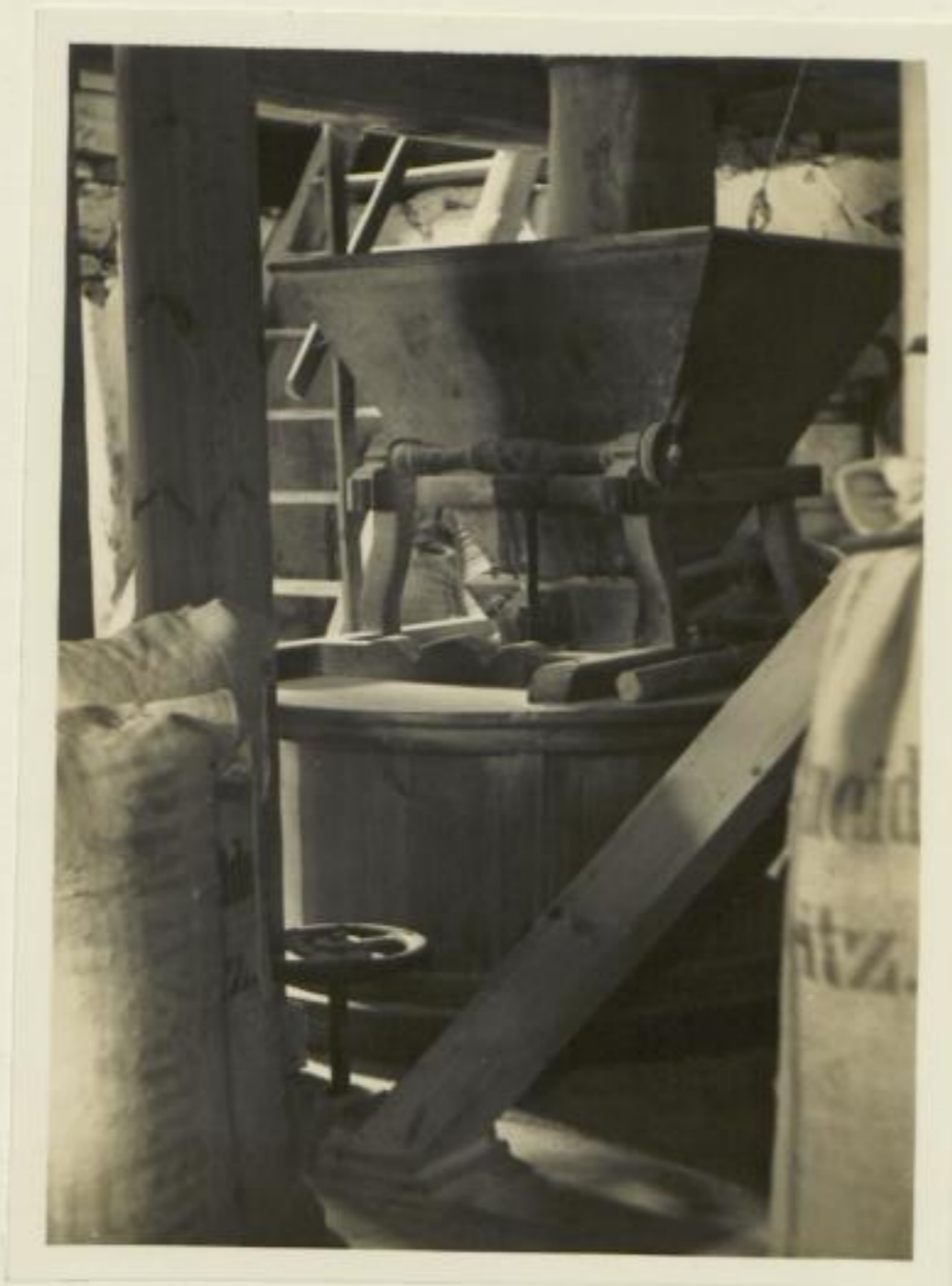
Abb. 30 Mahlgang, Schneidermühle, Soritz
