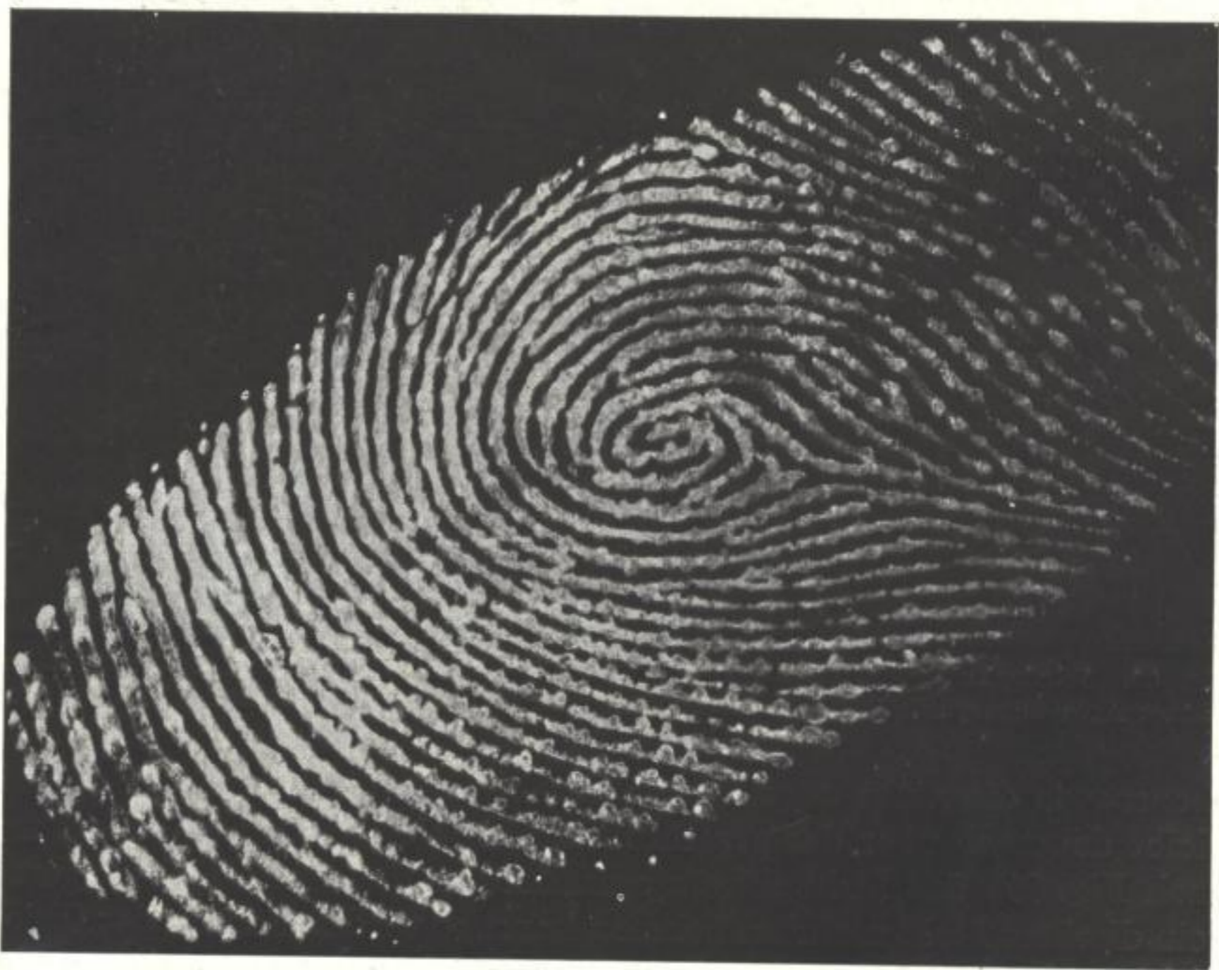
Fig. 68. Fingerabdruck auf einer Glasplatte. Objektiv f = 10,5 cm; \beta' = 4 \times . Beleuchtung: Schlierenmethode. Ohne Filter. Platte: Perutz Silbereosin. Belichtungszeit 30".
