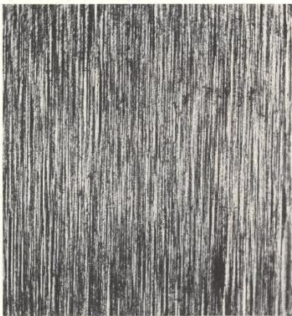
Fig. 93. Stahlwelle geschliffen. Objektiv 0,16/6; [ Okular 10 × ; \beta' = 30 \times . Filter: gelb. Platte: Perutz Braunsiegel. Belichtungszeit 5'. Werkphoto Busch, phot. Dr. STADE.
