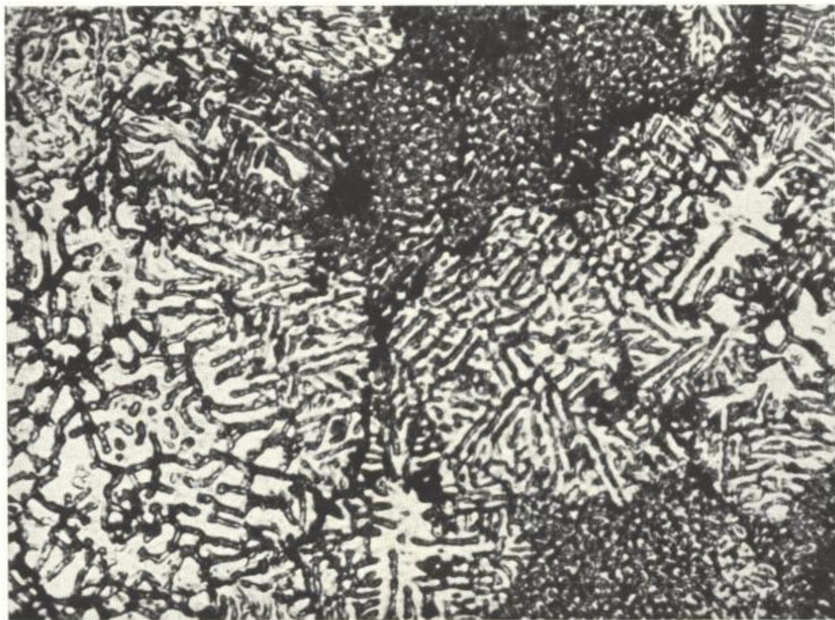
Fig. 82. Aluminiumschweißnaht. Objektiv 0,85/60; Okular 10 ×; \beta' = 1200 \times . Beleuchtung: Auflicht-Hellfeld. Filter: gelbgrün. Platte: Perutz Silbereosin. Belichtungszeit 1½'. Werkphoto Busch, phot. Dr. STADE.
