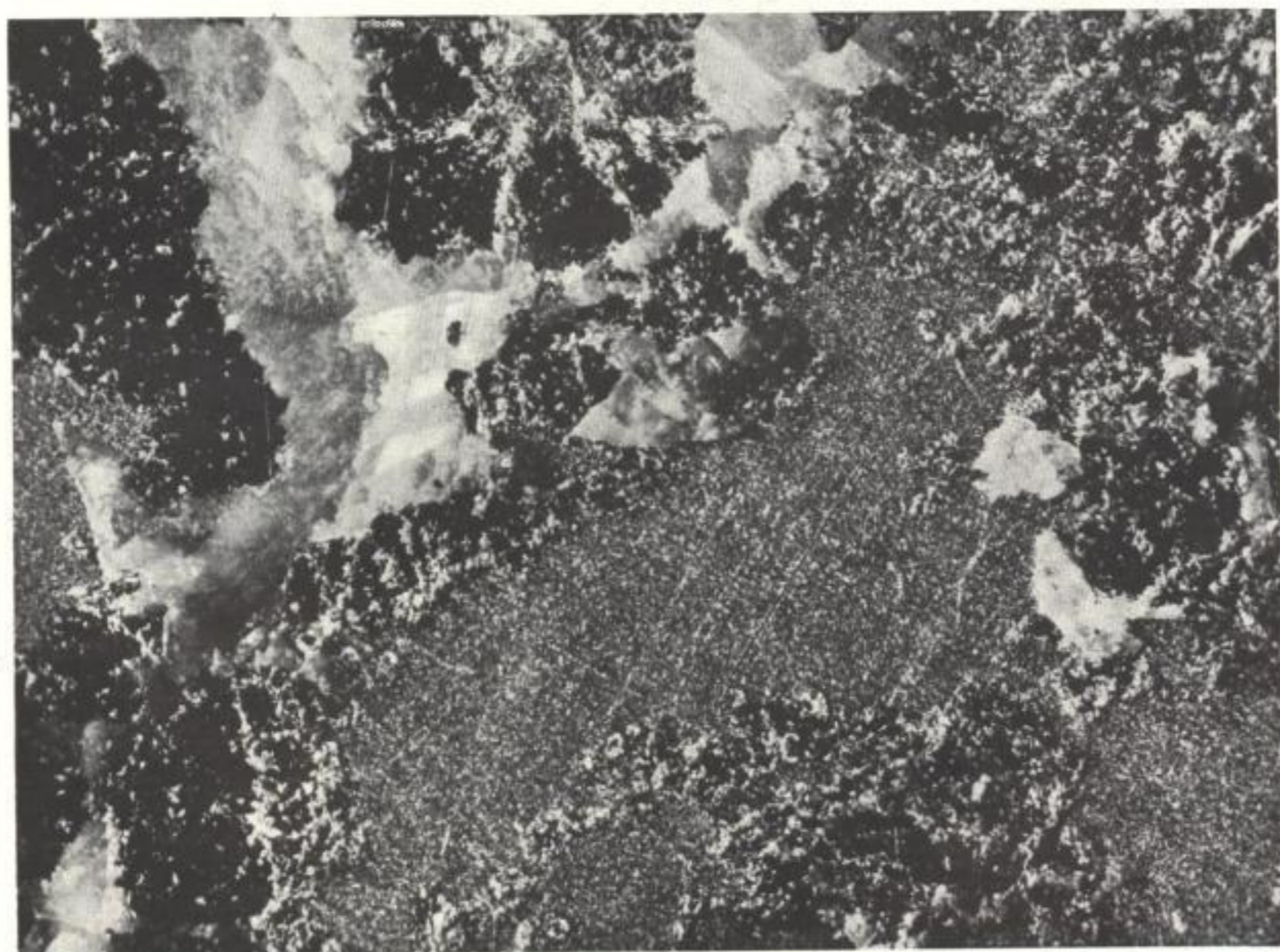
Fig. 90. Kupferkies im Sanderz. Objektiv f = 5,5 cm; \beta' = 11,5 \times . Beleuchtung: Auflicht-Dunkelfeld. Filter: gelbgrün. Platte: Perutz Braunsiegel. Belichtungszeit 3'. Werkphoto Busch, phot. Dr. STADE.
