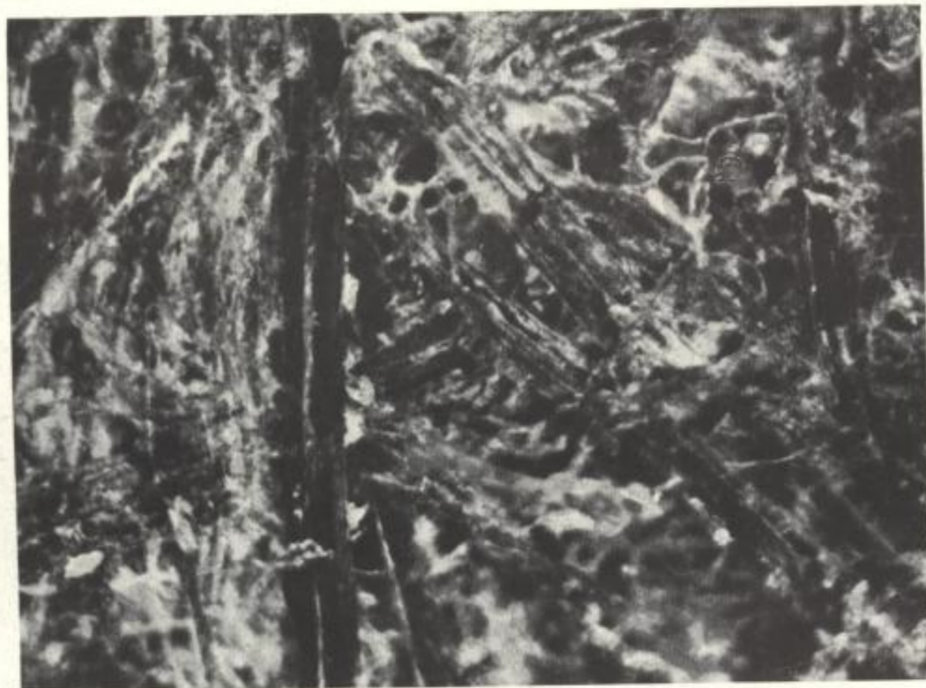
Fig. 99. Strohpappe. Objektiv 0,25/11; Okular 7,5 ×; \beta' = 165 \times . Nachträglich verkleinert auf \frac{1}{5} . Beleuchtung: Auflicht-Dunkelfeld. Filter: blaugrün. Platte: Perutz Silbereosin. Belichtungszeit 7'. Werkphoto Busch, phot. H. POLENSKI.
