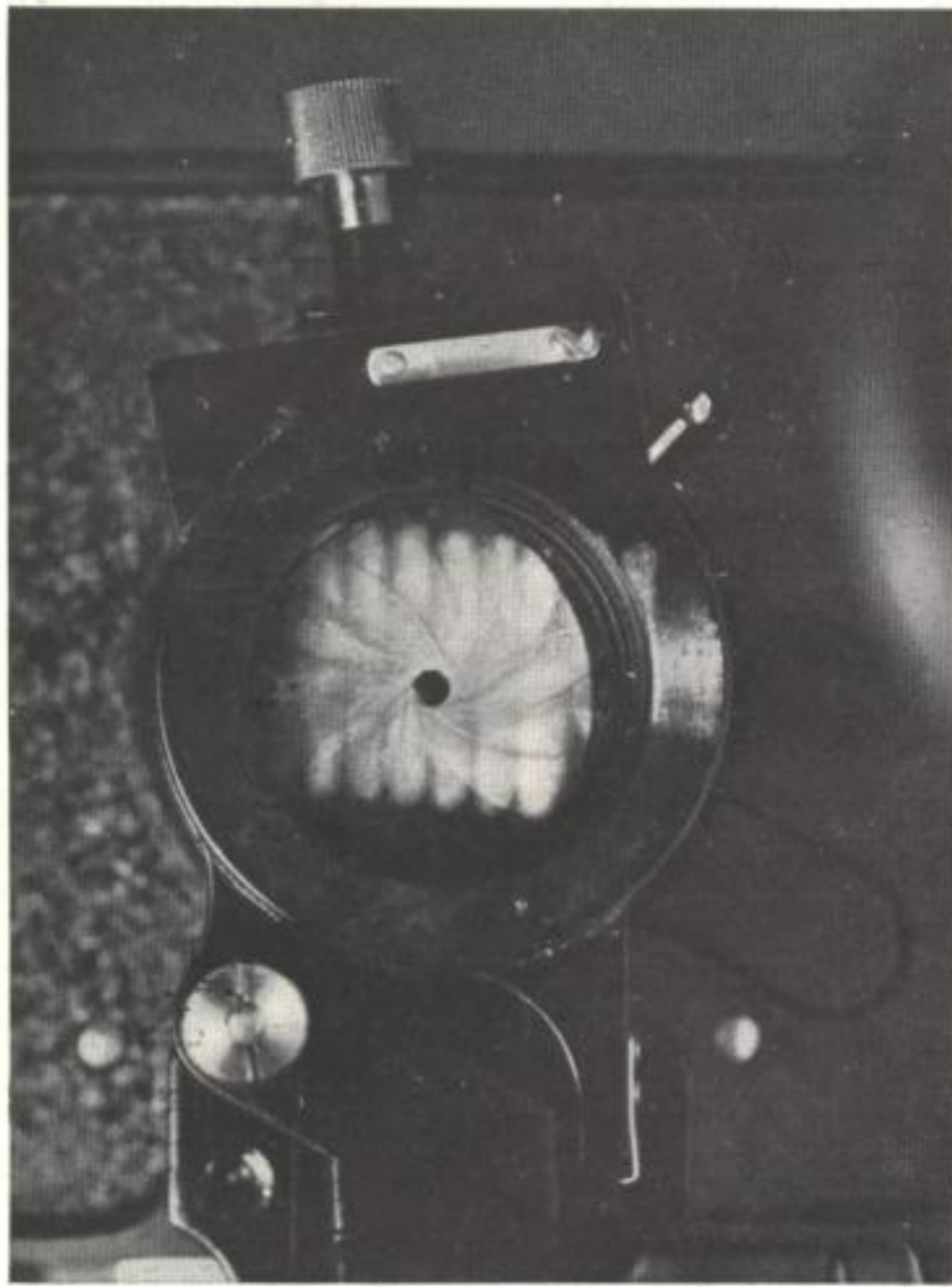
Fig. 43b. Bild des Glühfadens einer Niedervoltlampe auf der Kondensorblende. Werkphoto Busch, phot. H. POLENSKI.
