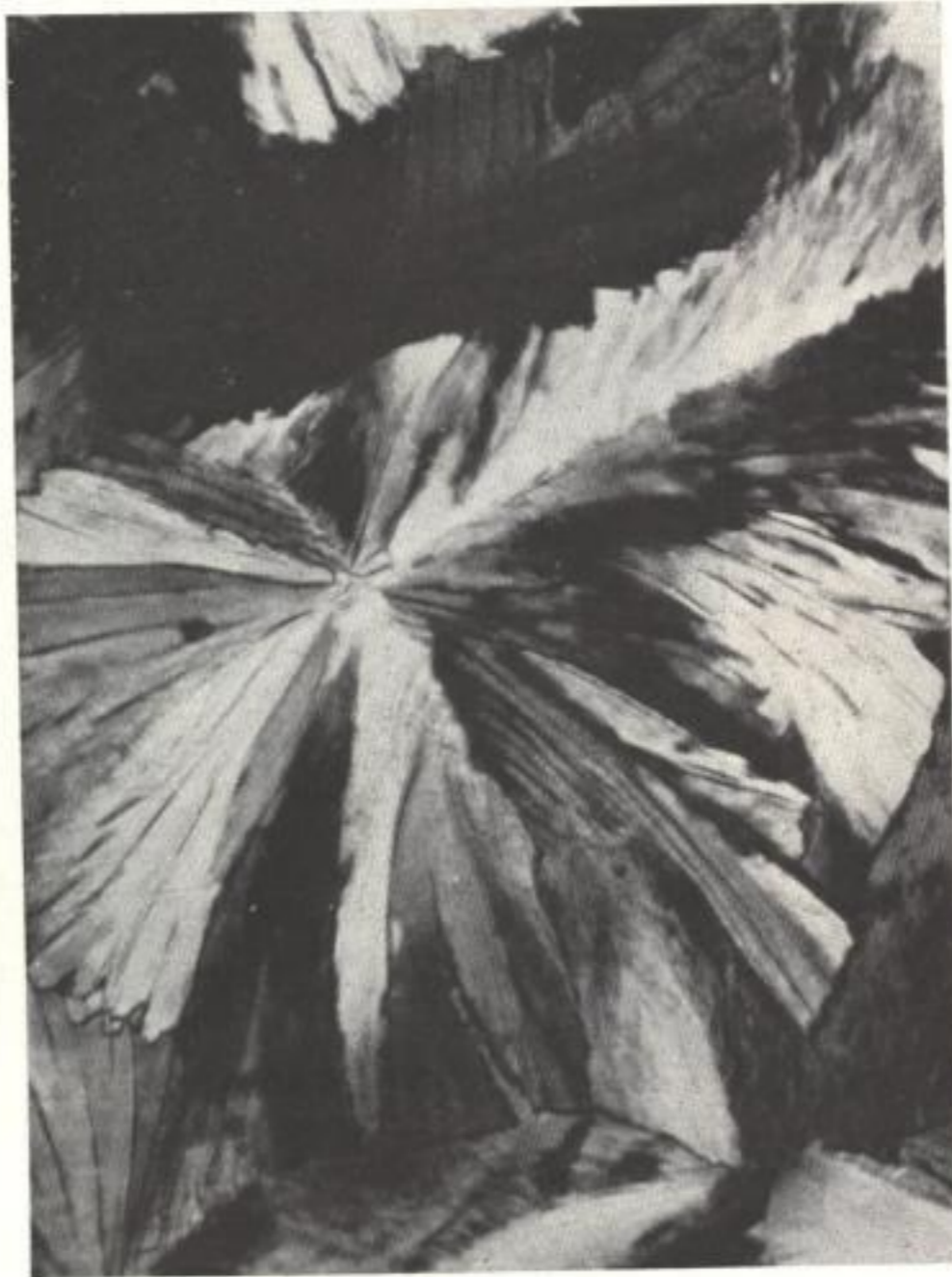
Fig. 122. Kalium citrium zwischen gekreuzten Nicols. Objektiv 0,25/11; Okular 10\times ; \beta' = 220\times . Nachträglich verkleinert auf \frac{4}{5} . Beleuchtung: Durchlicht-Hellfeld. Ohne Filter. Platte: Hauff Extra Rapid. Belichtungszeit 45". Werkphoto Busch, phot. H. POLENSKI.
