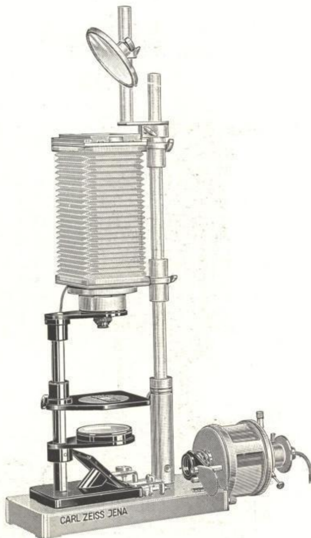
Fig. 148. Standard-Kamera für Makrophotographie im Durchlicht.
