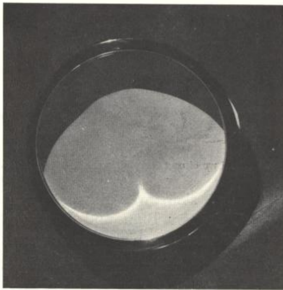
Fig. 20b. Kaustik durch Spiegelung an einem Ring.
