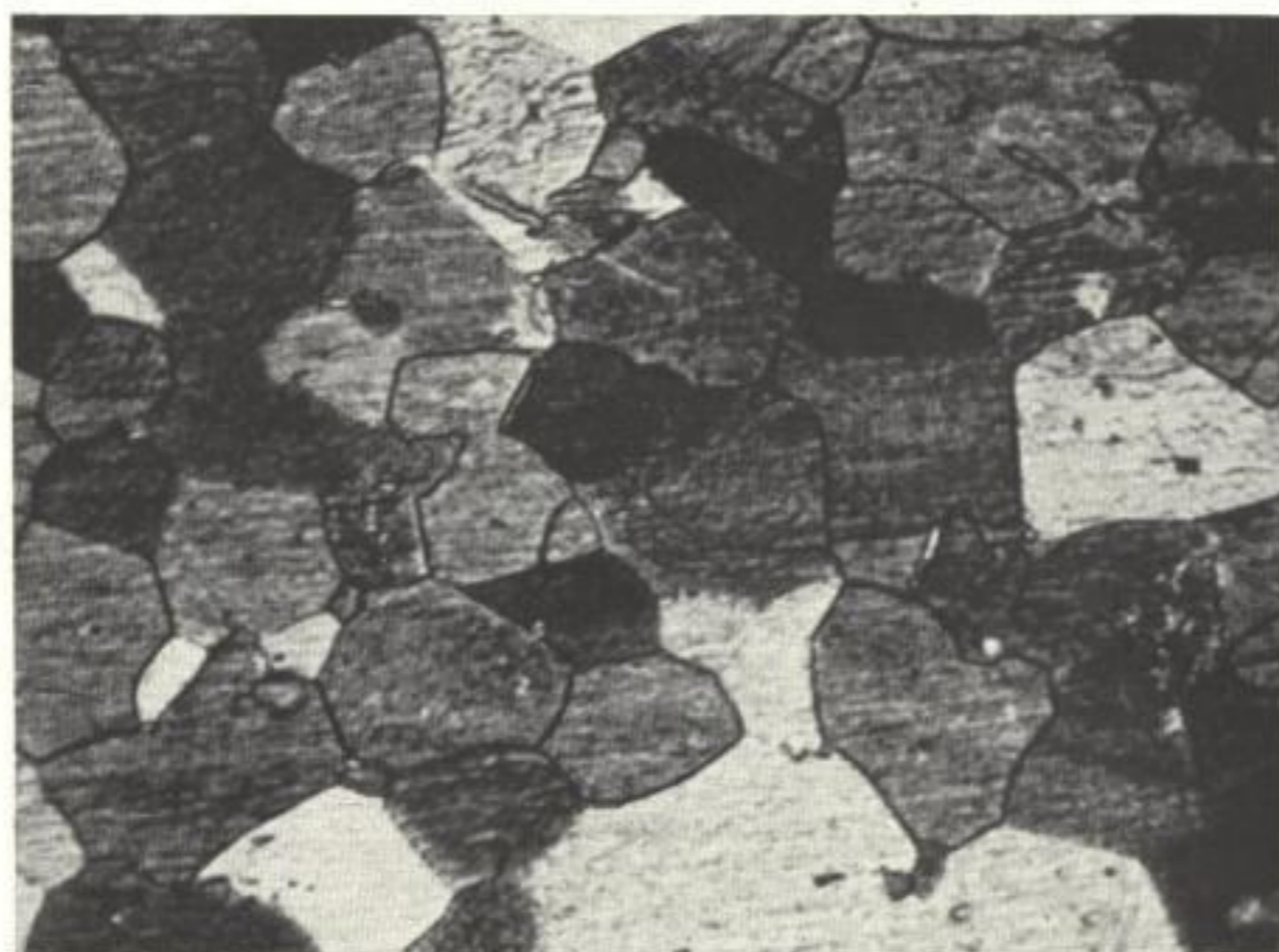
Fig. 85. Ferritkristalle. Objektiv 0,85/45; Okular 10\times ; \beta' = 900\times . Nachträglich verkleinert auf \frac{1}{5} . Beleuchtung: Auflicht-Hellfeld. Filter: blaugrün. Platte: Perutz Silbereosin. Belichtungszeit 1\frac{1}{2}' . Werkphoto Busch, phot. Dr. STADE.
