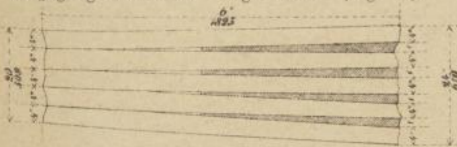
Fig. 7. Schlußpaket für die Walzeisenfundamentplatte einer Compound-Panzerplatte von oben 12", unten 8" Dicke.
