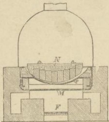
Zinkbades auf eine geringe Höhe, vorgewärmt, und es wird die Bildung von Hartzink möglichst vermieden und eine dünne sehr haltbare Zinküberzugsschicht erzielt. Zur Ausführung dieses Verfahrens dient ein mit Feuerung *F* versehener Kessel *M* mit feuerfesten Seitenwänden, einer feuerfesten Scheidewand *N* und den Eisenträgern *e*, welche ganz unter Blei liegen.
