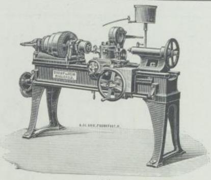
DREHBÄNKE mit Revolversupport.
