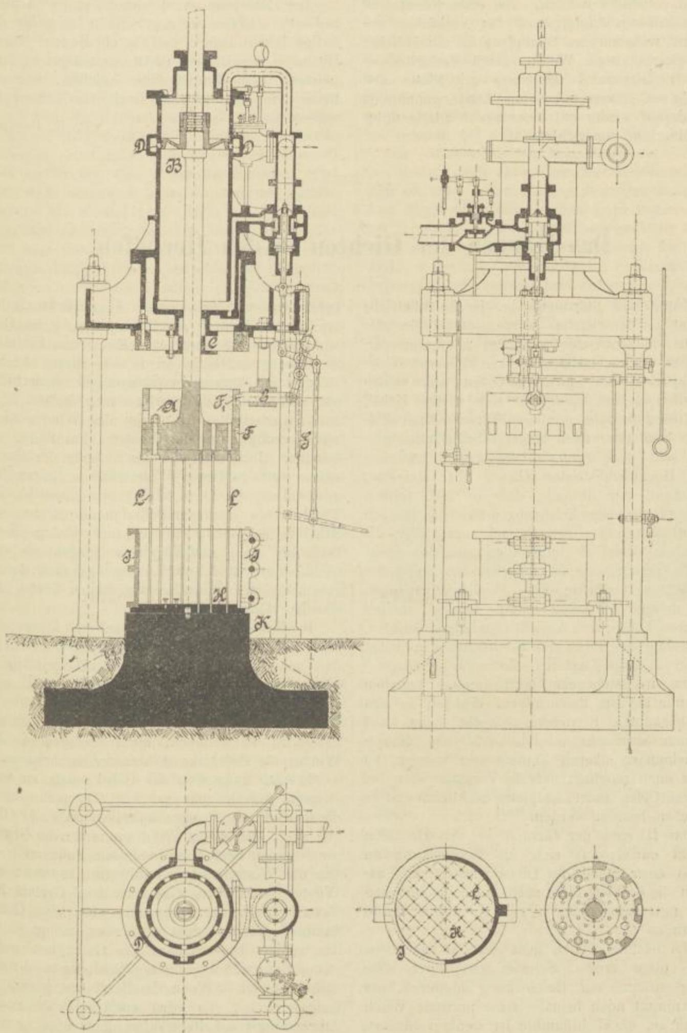
der Chabotte *K* befestigt und die Nadeln *L* eingesteckt sind, wird der Stampfer soweit heruntergelassen, daß der Daumen *E* in die Vertiefung *F*<sub>1</sub> eingreift. Das zum Stampfen von Theermasse
