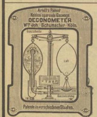
Oeconometer. Arndt's Patent Kohlen sparende Gaswaage. Nützlichstes Ausrüstungs-
