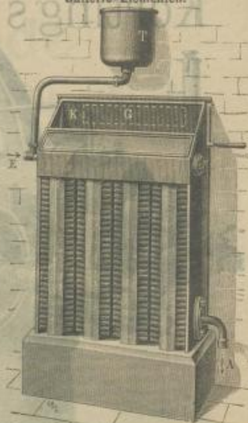
Körting's Rippenkühler aus Patent-Batterie-Elementen.
