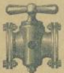
Fig. 1. Hähne mit Flachen für Maschinen.
