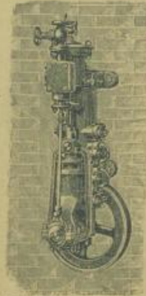
Fig. 1. Einfachwirkend mit Plungerkolben. - Doppeltwirkend mit Scheiben- resp. Manschettenscheiben.
