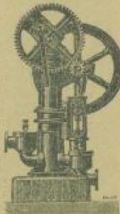
Fig. 2. Maischepumpe mit directem Dampftrieb.
