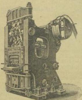
Auf dieser Presse können Steine aus Thonschiefer, Cement, Sand, Schlackensand etc. angefertigt werden. Garantirte Leistung bis zu 2200 Stück pro Stunde. Billigste Fabrication bei glattem, scharfkantigem, vollkommen rifsfreiem Product, dabei von genau gleicher Höhe.
