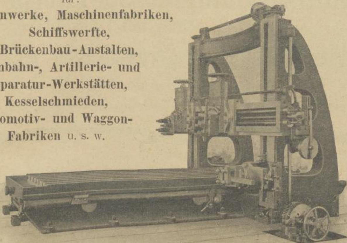
Hobelmaschine von 6000 mm Hobellänge, 2000 mm Hobelbreite,
