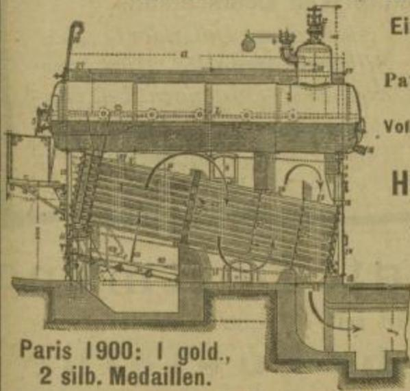
Eingeführt bei der Kriegs- und Handelsmarine. Patentirt in allen größeren Staaten Europas. Vollständig getrennte Wasser- u. Dampf-Circulation.
