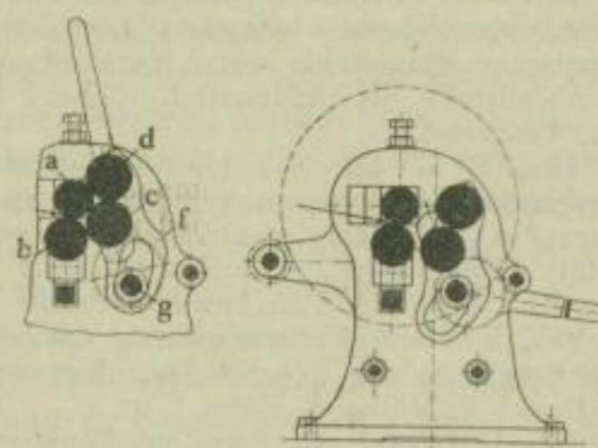
*b c* und *d a* unverschiebar gelagert, *b* ist in senkrechter Richtung verstellbar, *d* hingegen ist in Schildern *f* gelagert, die sich um Zapfen der beweglichen Biegewalze *c* drehen und deren Verlängerungen als über eine Welle *g* greifende Kurvenschlüsse ausgebildet sind. Durch Anheben der Walze *c* findet somit eine zwangsläufige Bewegung der Walze *d* statt.
