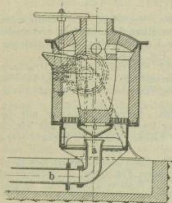
wird, während sich beim Kippen des Ofens der Windzutrittsstutzen *a* von dem festen Zuleitungsrohr *b* abhebt, ohne daß ein Anheben des Ofens nötig ist.
