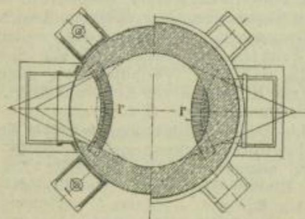
Die stehenden Roststäbe *r* sind nach einem den Innernraum des Ofenschachtes in konvexer Fläche abgrenzenden Kegelmantel bzw. einer schwachgewölbten Kugelfläche angeordnet, um sämtliche Stellen des zwischen den Rosten liegenden Schachtinhalts beim Schüren erreichen zu können.
