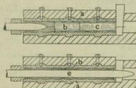
Das Verfahren bezweckt die Herstellung von Hohlkörpern durch Lochung und Streckung ungelochter Werkstücke, wobei ihnen eine erheblich größere Länge als den Anfangsstücken gegeben wird.
