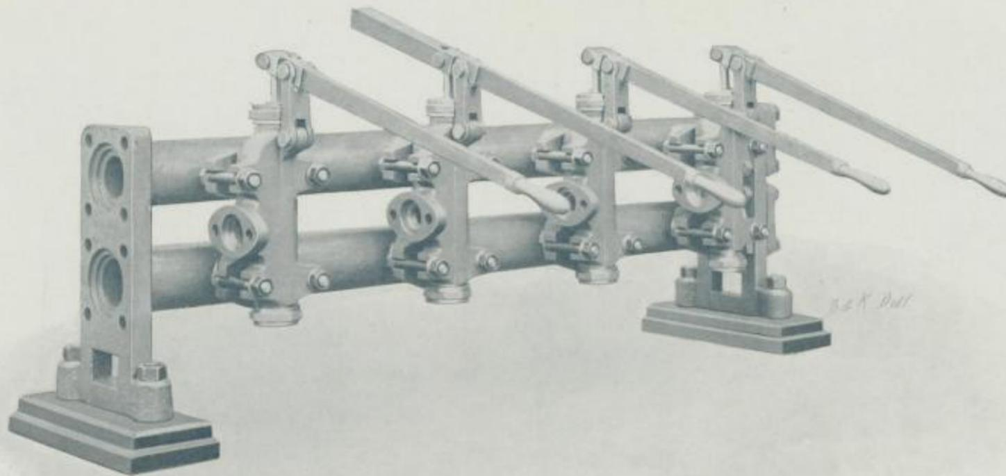
Gruppen von 6 und 4 stehend angeordneten hydraulischen Steuerapparaten.
