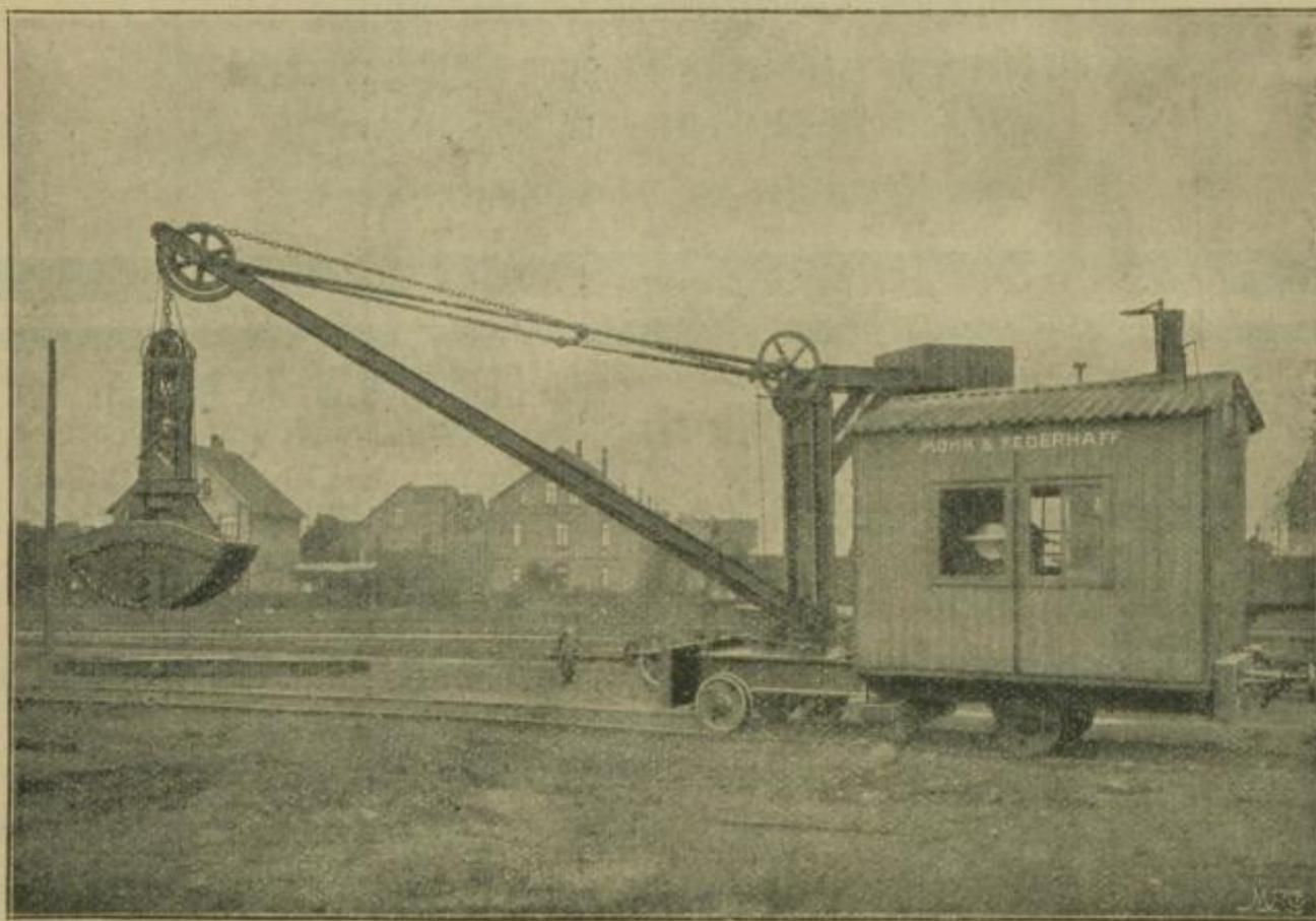
Lokomotiv-Dampfkran für Selbstgreiferbetrieb.
