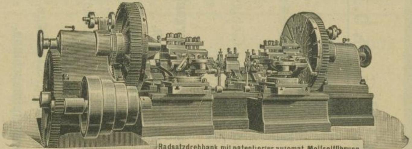
Radsatzdrehbank mit patentierter automat. Meißelführung von höchster Leistungsfähigkeit.
