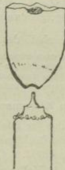
Fig. 2. — Der Bogen ist zu gross. Die Spitze der unteren Kohle ist verschwunden und eine violette, sichelförmige Flamme entsteht und verursacht das Flackern des Lichtes.
