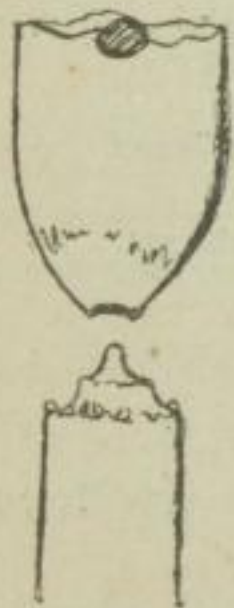
Fig. 1. — Der Bogen ist normal, da die Spitze der unteren Kohle gut gebildet ist.
