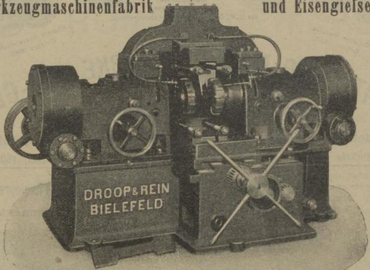
Doppelte **Fräsmaschine** für flache Zerreißproben
