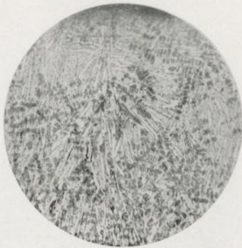
Lichtbild 3. V = 125. Weißes Eisen, Härteschicht Randpartie. Kristallisationszentren weißer Zementit, dunkler Perlit.
