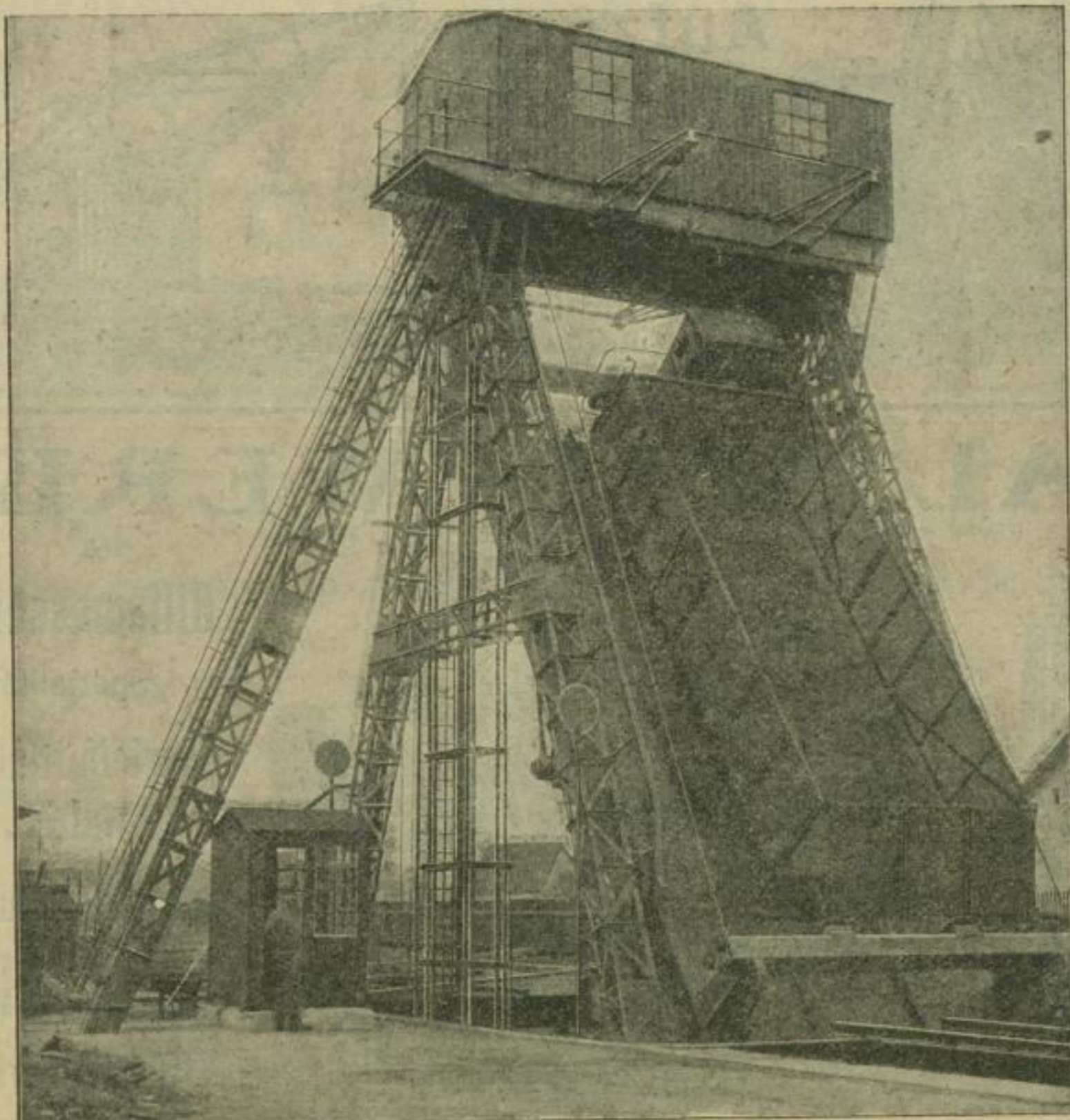
Elektrisch betriebener Waggonkipper (nach beiden Seiten kippbar). Stündl. Leistung 10 Wagen. Erforderliche Kraft 9 PS.
