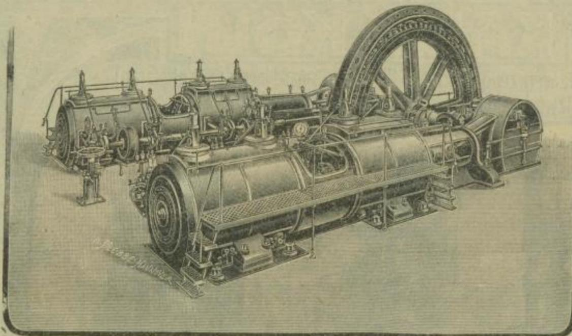
Schlamm-trocknungs-Apparate für städt. Kanalisations-Anlagen. 3077
