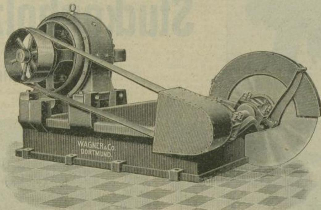
Schwere Blocksäge mit hydraulischem Vorschub.
