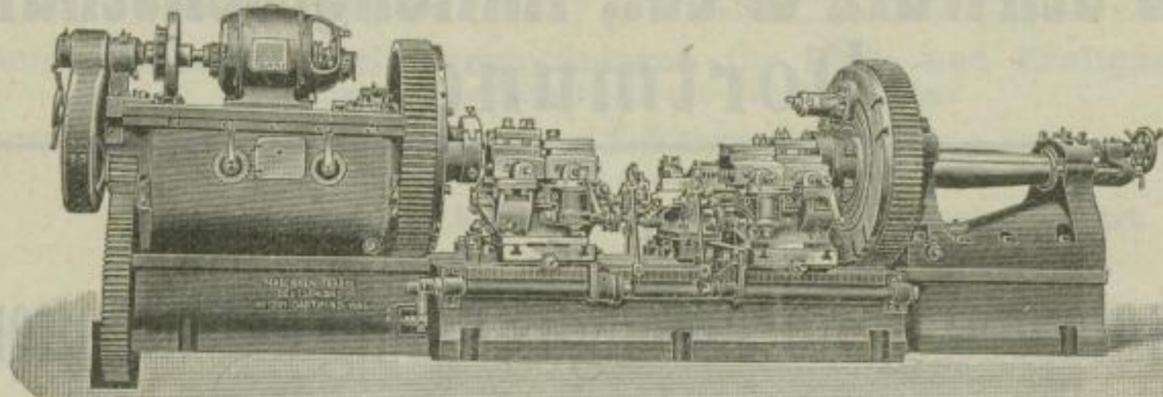
Radsatzdrehbank mit automat. Meißelführung, von höchster Leistungsfähigkeit, System „Deutschland“, D. R. P.
