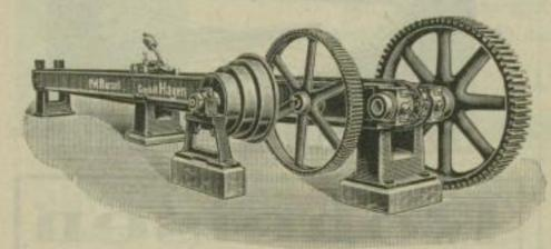
Ziehbänke für Stäbe und Rohre Kaltwalzwerke für Bänder in allen Metallen Drahtzieherei-Einrichtungen
