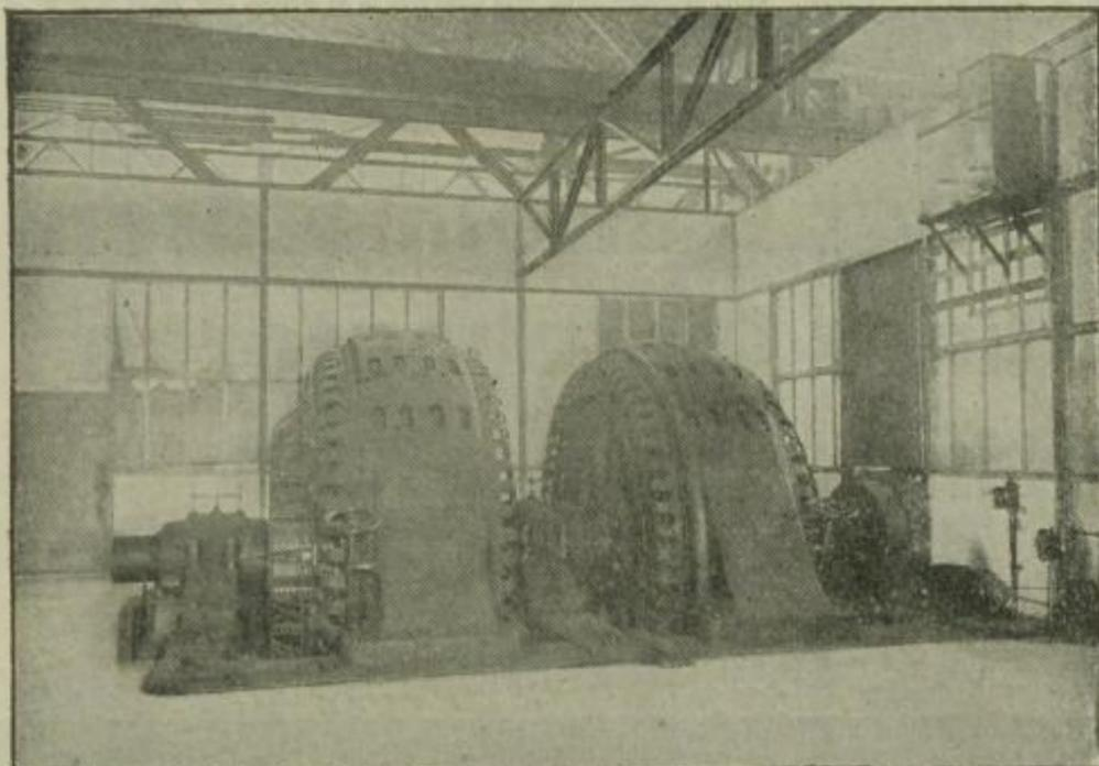
Antriebsmotoren für eine 800 er Knüppel-Reversierstrecke mit 5000 PS, Normal- u. 15 000 PS. Maximalleistung 0-120-160 U. p. M. Geliefert für die Rombacher Hüttenwerke.
