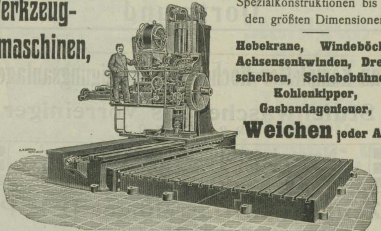
Horizontal-Bohr- und Fräsmaschine, 200 mm Spindeldurchmesser, 1536 b
