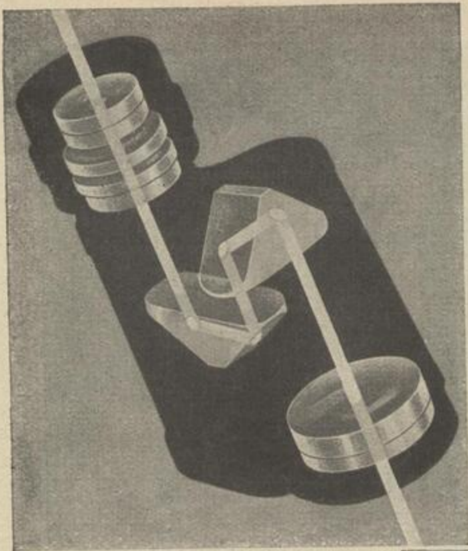
Bild 173. Strahlengang im einäugigen Prismenfeldstecher
