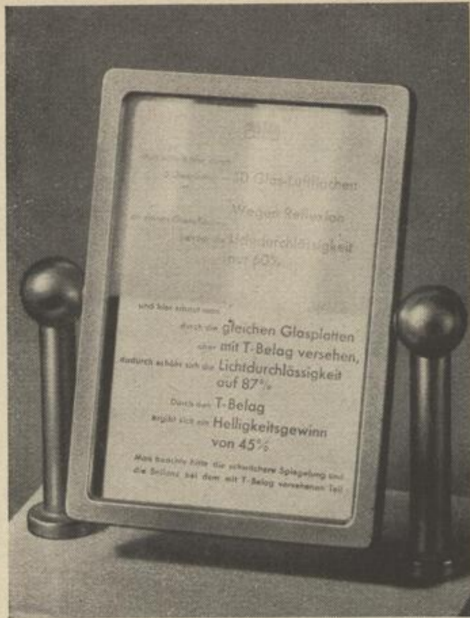
Bild 88. Die Wirkung des T-Belags. Eine mit Schrift unterlegte Glasplatte ist im oberen Teil unverändert, im unteren Teil mit T-Belag versehen. Oben erschweren Lichtreflexe das Lesen und führen durch Bildung eines Reflexschleiers zur Verringerung der Kontraste; die Schrift erscheint grau. Unten ist bei einem Helligkeitsgewinn von 45% die Bildbrillanz gehoben, und die Schrift steht klar und schwarz auf hellem Grund
