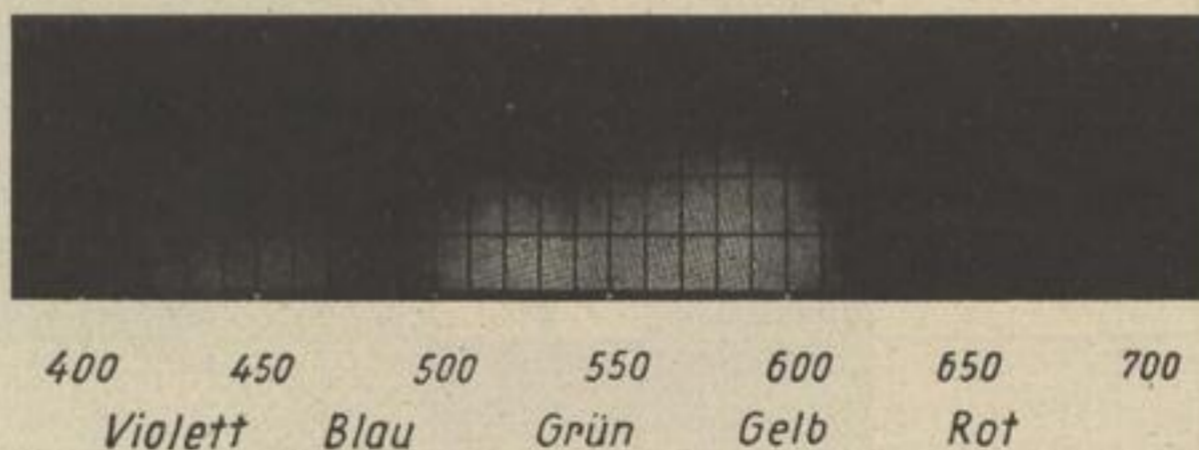
Bild 334. Spektralkurve für Autolithplatte panchromatisch
