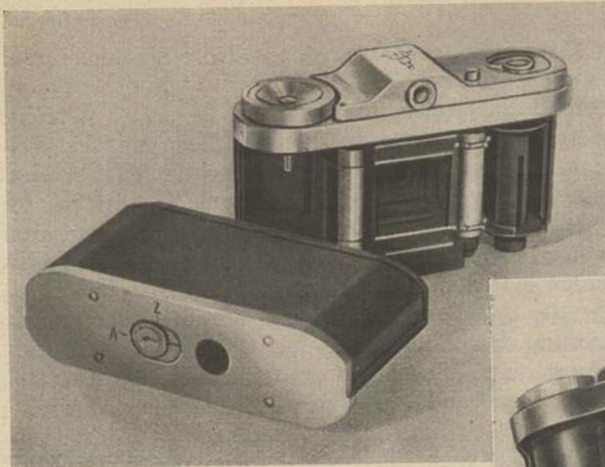
Bild 145. Einspulen des Kleinbildfilms in die Taxona. Die linke Filmkammer nimmt die Kassette mit dem unbelichteten Film auf. In der rechten Filmkammer befindet sich die Aufwickelspule. Die Zähne der Transportrollen greifen in die Filmperforation ein
