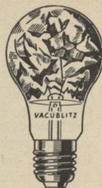
Bild 236. Vakublitz, ein mit Sauerstoff und einer Leichtmetallfolie gefüllter Glaskolben
