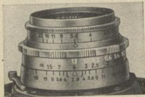
Bild 157. Blendeneinstellung und Tiefenschärfering am Objektivstutzen der Exa; Objektiv mit Rastblende
