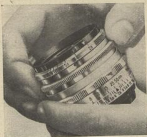
Bild 124. Einstellung der Blendenvorwahl. Ein mit Anschlag versehener Vorwahlring wird auf die Arbeitsblende eingestellt. Dann stellt man das Objekt auf der Mattscheibe bei voller Objektivöffnung scharf ein und dreht vor der Aufnahme die Blende bis zum Anschlag des Vorwahlrings
