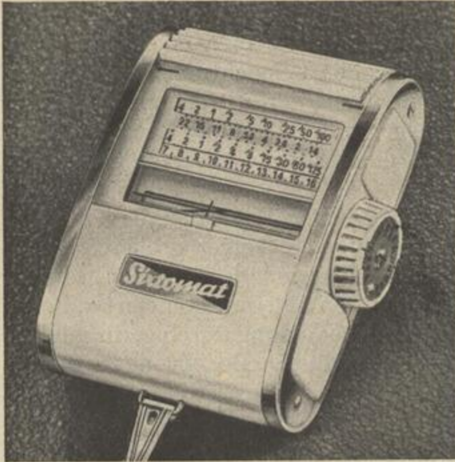
Bild 200. Sixtomat x 3, moderner elektrischer Belichtungsmesser der Firma Gossen, Erlangen, für Objekt-, Licht- und Kontrastmessung. Zwei Belichtungszeitskalen für die beiden gängigen Verschlussteilungen mit Gangzahlmarken fürs Filmen bewegen sich gegen die feststehende Blendenskala. Neu sind Einstellung auf Punktschärfe mit Hilfe eines Meßkreuzes, zusätzliche Lichtwertskala und Farbtemperaturmessung für Farbaufnahmen mit Hilfe eines Colorfinders auf der Rückseite des Geräts. Rechts Stellknopf für Filmempfindlichkeit
