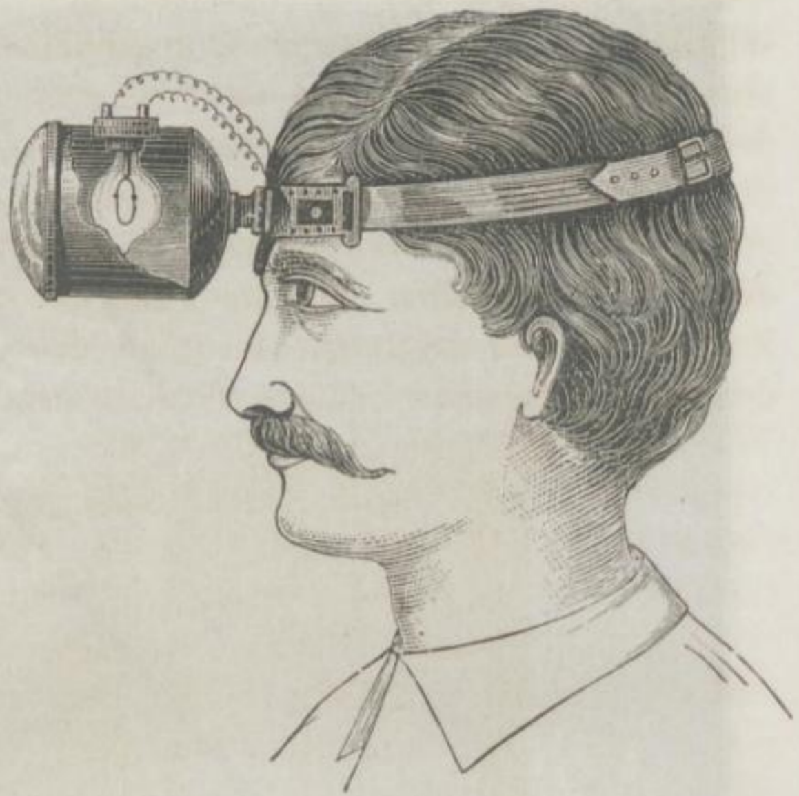
Fig. 460. Jirasko's elektrische Stirnlampe.
