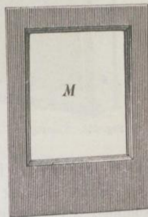
Fig. 323. Matte Scheibe zum Apparate Fig. 320.
