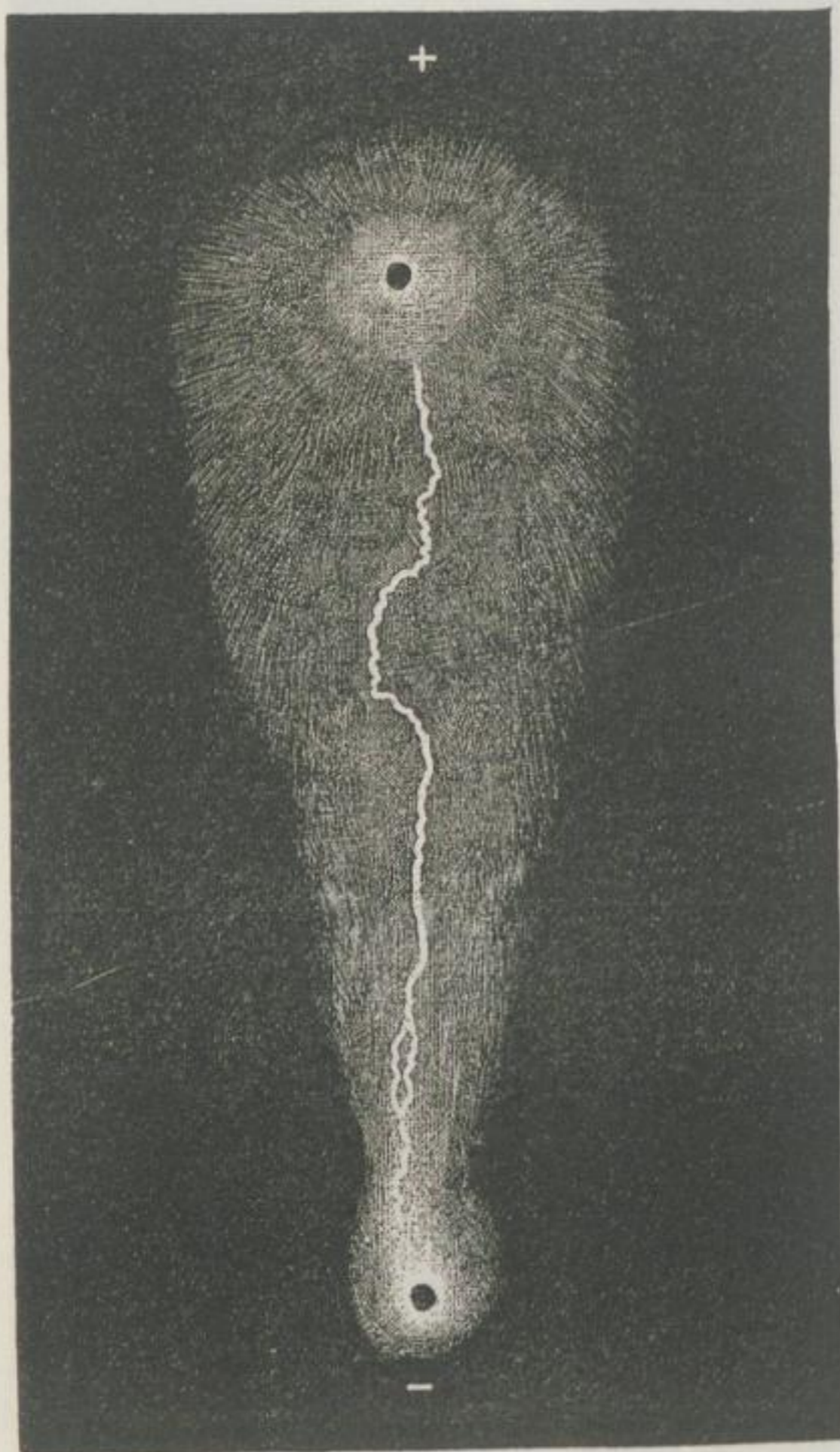
Fig. 112. Funkenphotographie mittels einer Holtz'schen Influenzmaschine.
