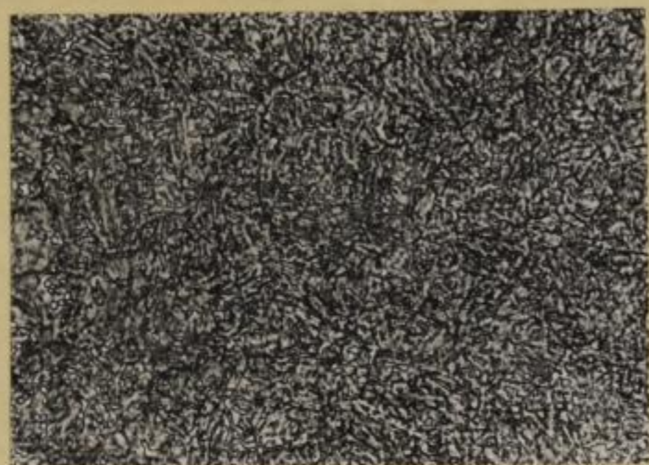
Bild 46 500 : 1 Gefügebrausbildung nach Zwischenstufenvergütung bei 390^{\circ}\text{C} \pm 2 \text{ grad} (Ätzmittel: 2%ige alkoh. \text{HNO}_3 )
