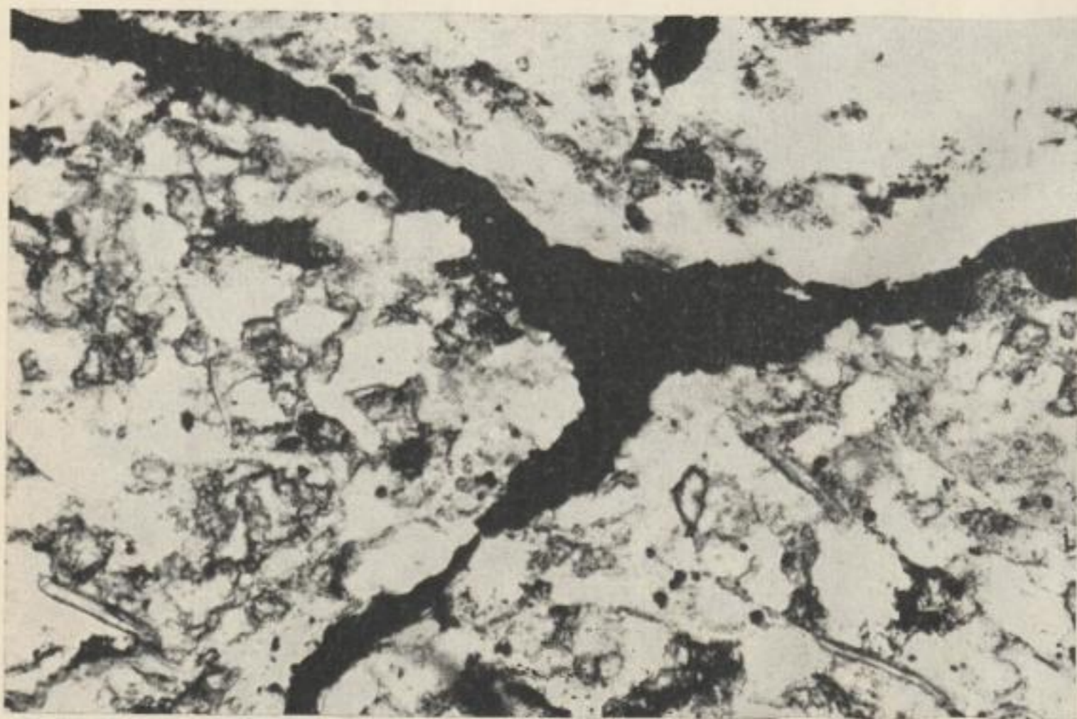
Bild 47. Unterer Metallhorizont, T3; Nichtfigurierte inkohlte organische Substanz (ehemalige Huminverbindungen oder Polymerbitumen); Bucht von Crimmitschau, Aufschlußpunkt 8; // Nic., Vergr. 60 ×
