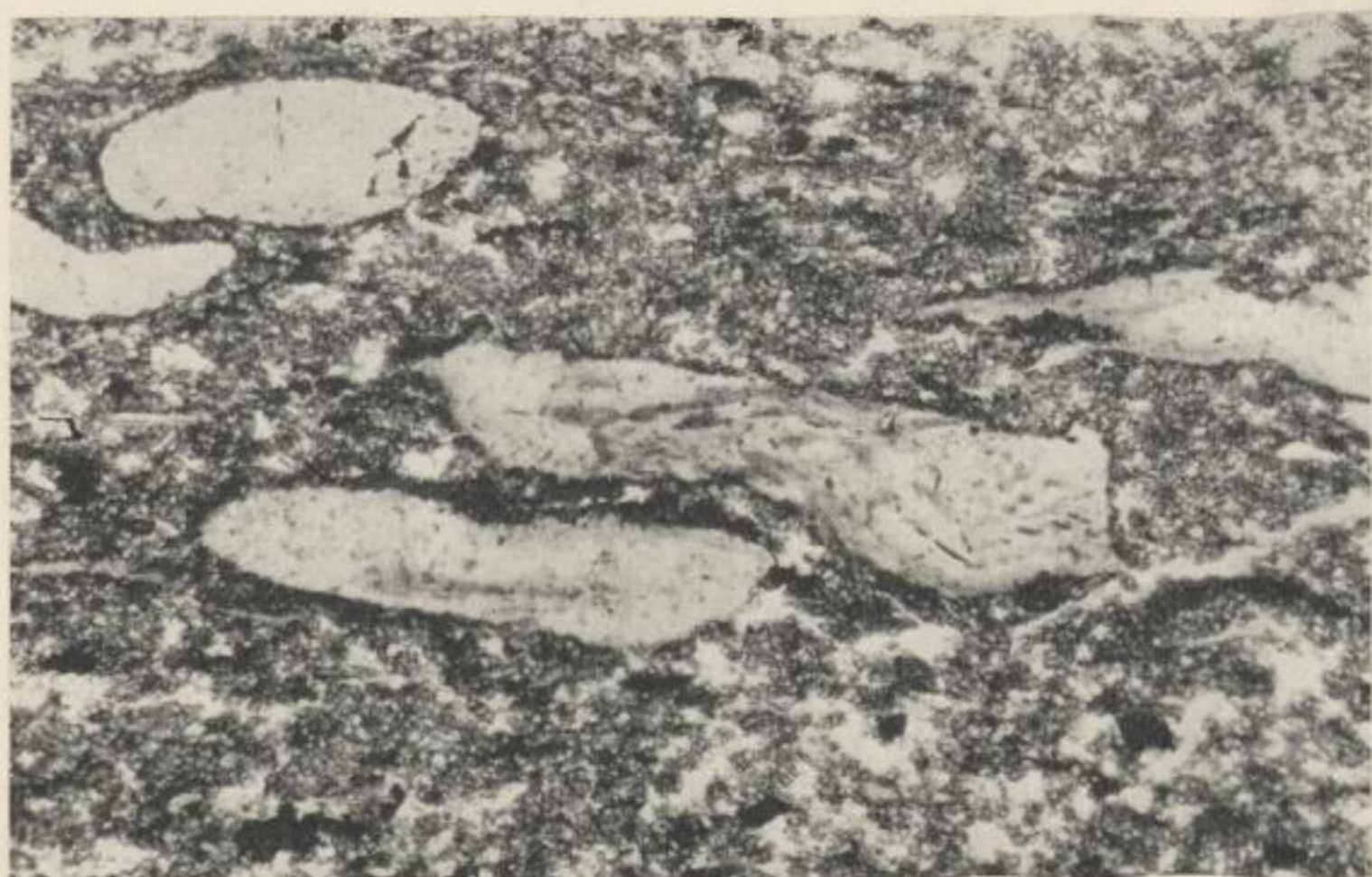
Bild 38. Oberer Metallhorizont, z_{02} , feinkristalliner, toniger Dolomit mit Proto-bitumina (Resinite): bei Frohburg, Aufschlußpunkt 75; // Nic., Vergr. 60 ×
