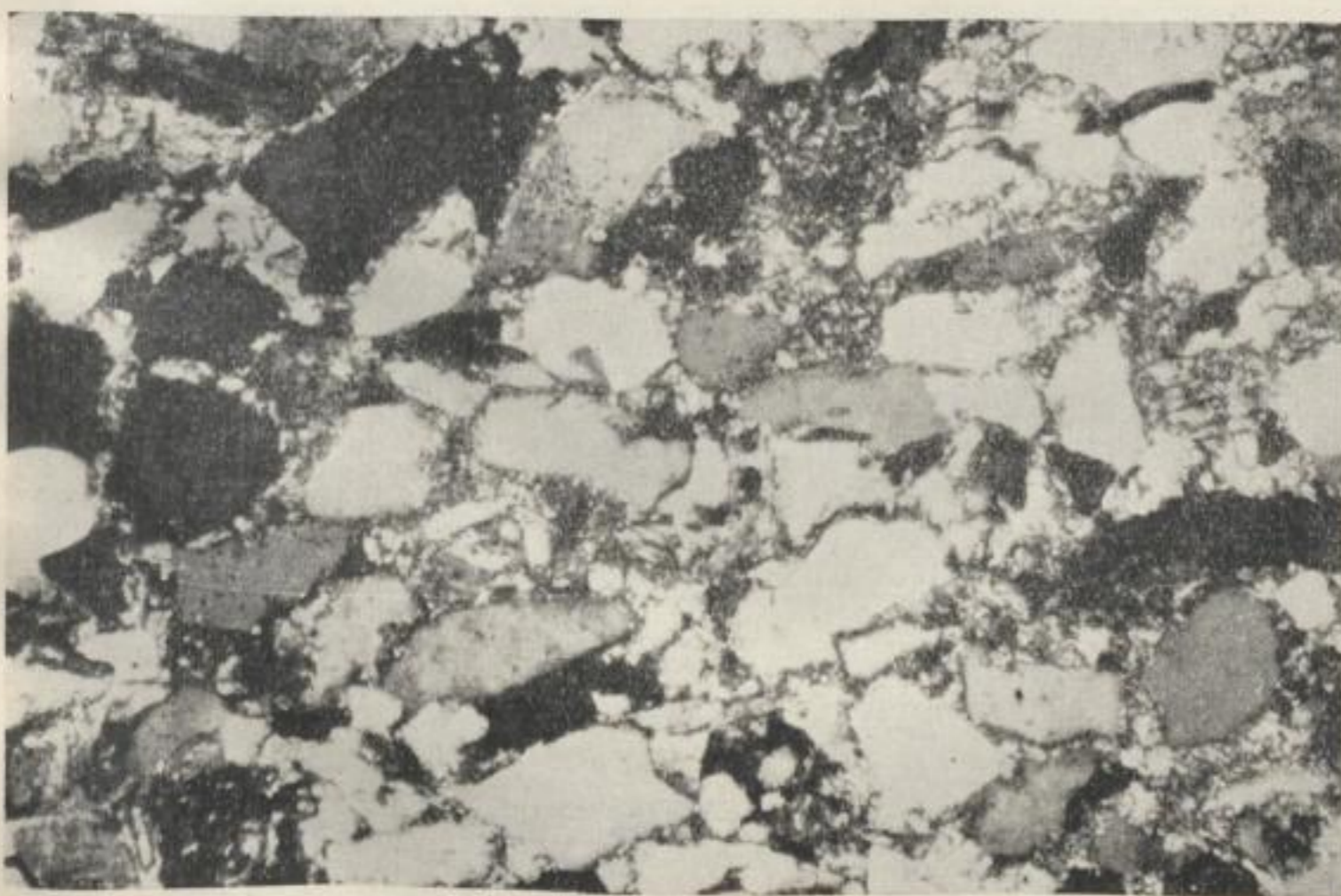
Bild 32. Sandstein, mittelkörnig, gut sortiert; Schwemmkegel, T3; Bucht von Lehdorf; Aufschlußpunkt 63; + Nic., Vergr. 60 ×
