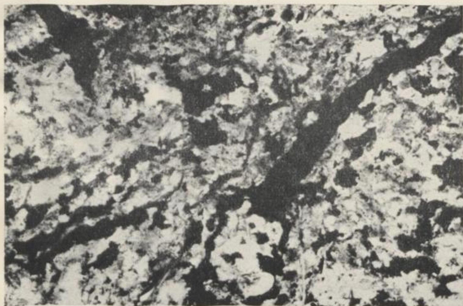
Bild 45. Unterer Metallhorizont, T3; Schiefertone mit inkohlem Pflanzendetritus (schwarz); Bucht von Frohburg—Geithain; Aufschlußpunkt 76; // Nic., Vergr. 60 ×
