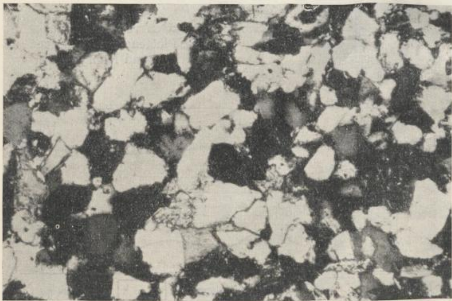
Bild 26. Sandstein, fein- bis mittelkörnig; Schwemmkegel, T3; Bucht von Lehdorf; Aufschlußpunkt 60; + Nic., Vergr. 60 ×
