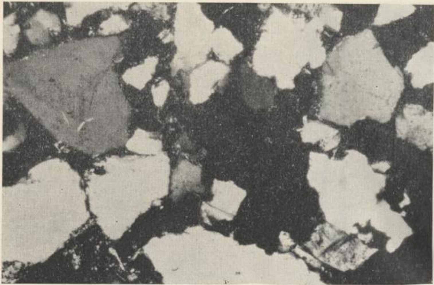
Bild 25. Sandstein, mittel- bis grobkörnig; Schwemmkegel, T3; Bucht von Frohburg— Geithain; Aufschlußpunkt 77; + Nic., Vergr. 60 ×
