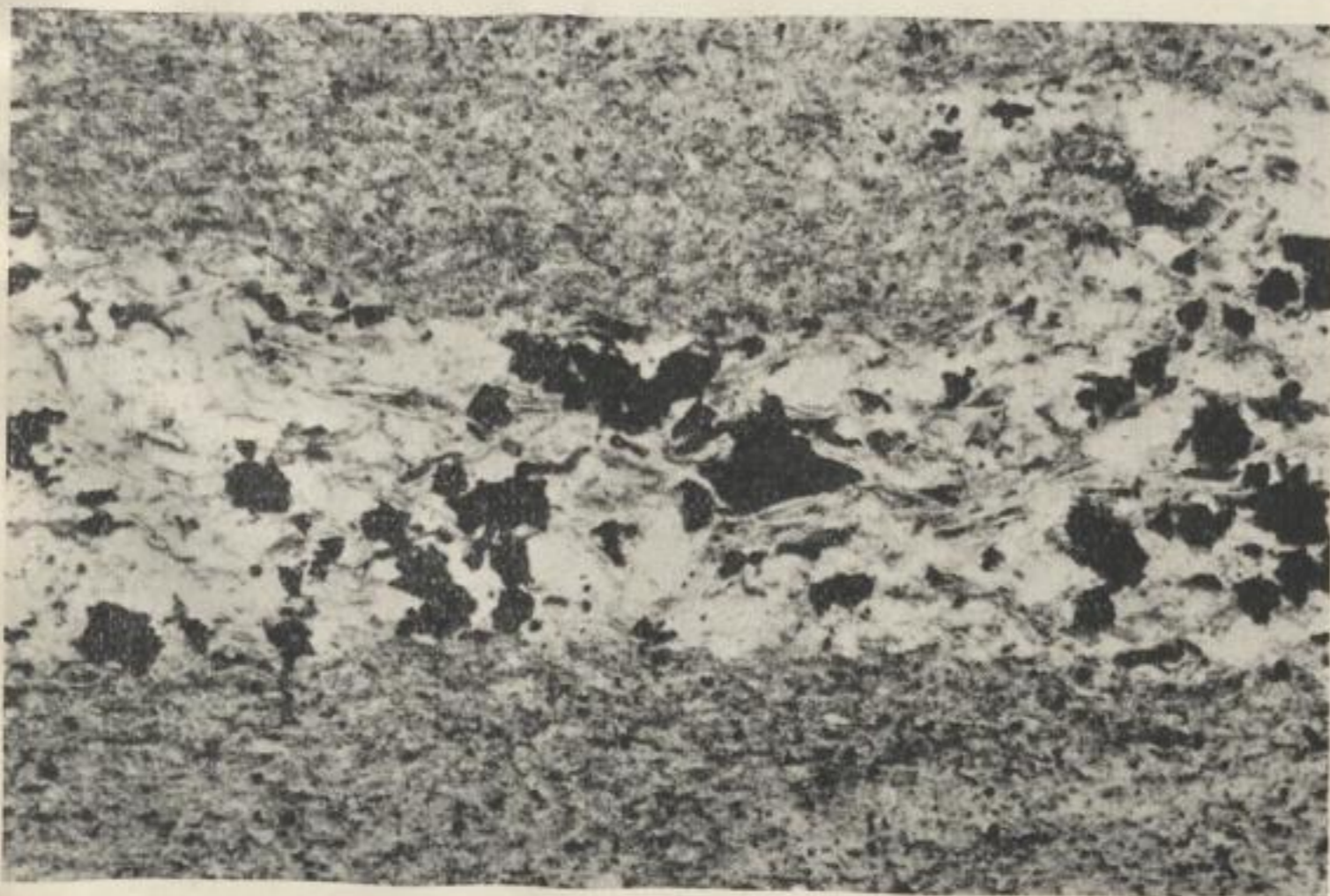
Bild 49. Oberer Metallhorizont, Ca3/Z3r; Sulfide in größeren Lagen des Schiefertones (schwarz); Frohburg; Aufschlußpunkt 71; // Nic., Vergr. 60 ×
