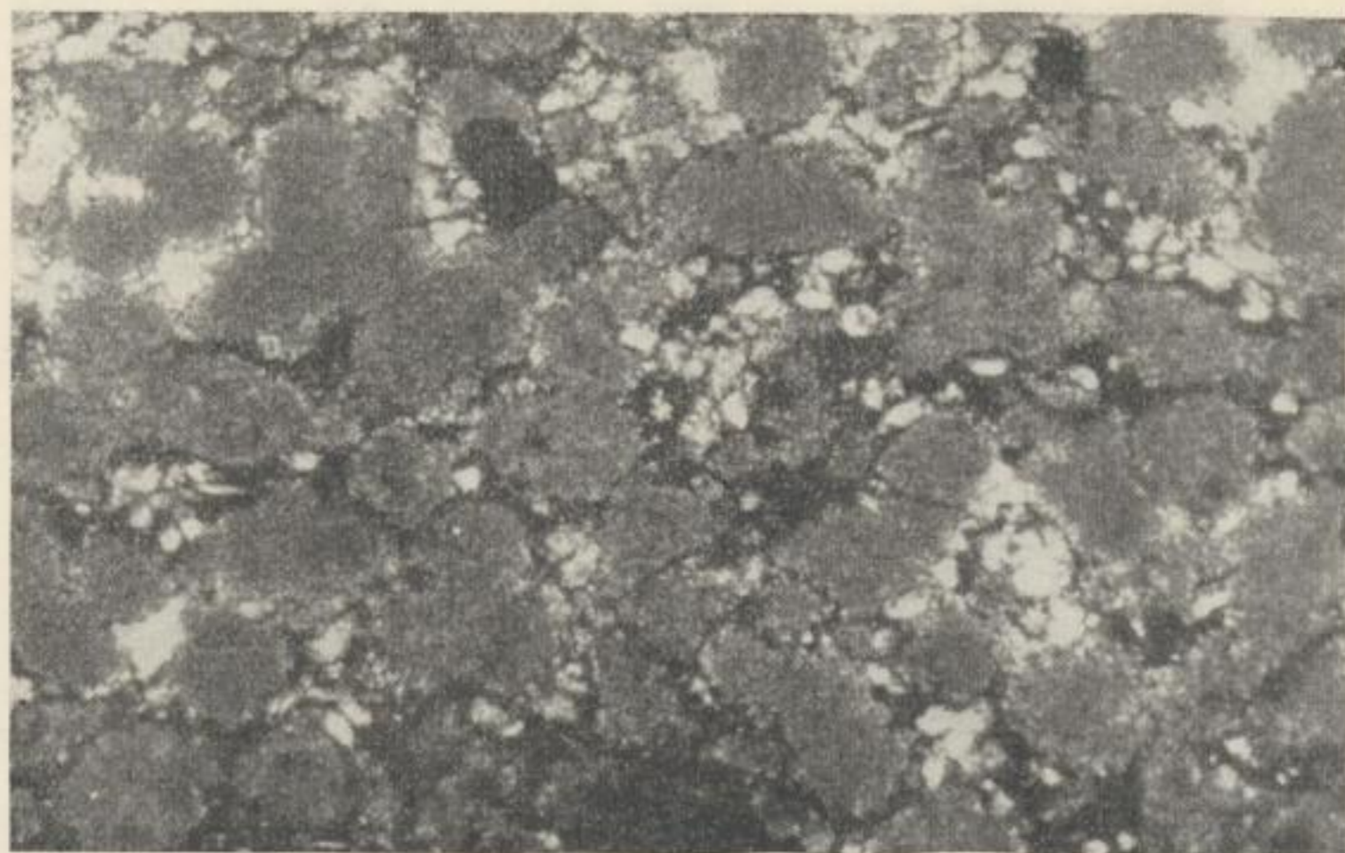
Bild 37. Oberer Metallhorizont, z_{02} , typische Primärstruktur, Dolomitekretionen (grau), Bitumen als Bindemittel (schwarz), reichlich Quarzdetritus (weiß); bei Hopfgarten, Aufschlußpunkt 82; // Nic., Vergr. 60 ×
