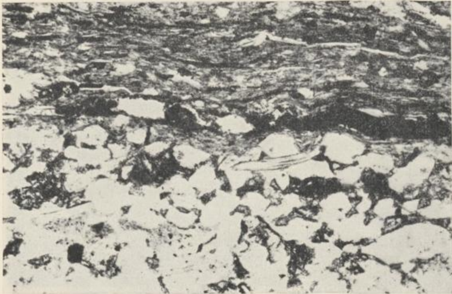
Bild 42. Unterer Metallhorizont, T 3; Schiefertone mit optisch gut und schwer auflösbarem Anteil sowie opaker Substanz (schwarz); Schmölln, Aufschlußpunkt 43; // Nic., Vergr. 60 ×
