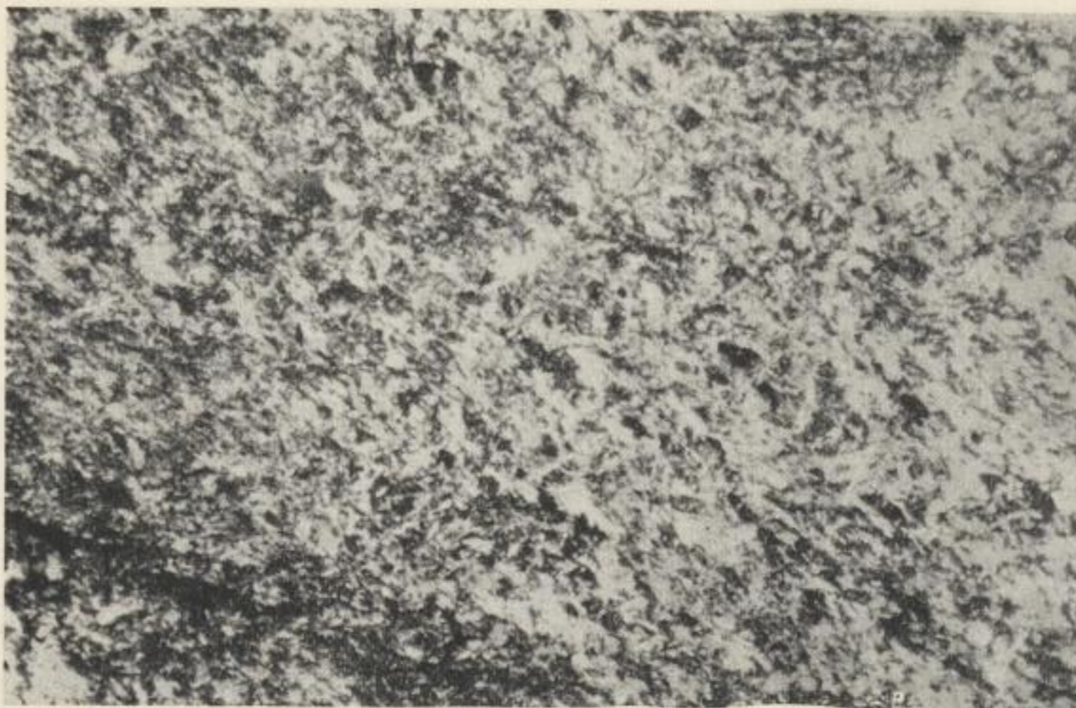
Bild 29. Schiefer-ton, illitisch, Horizont T 3; Bucht von Lehdorf; Aufschlußpunkt 63; + Nic., Vergr. 60 ×
