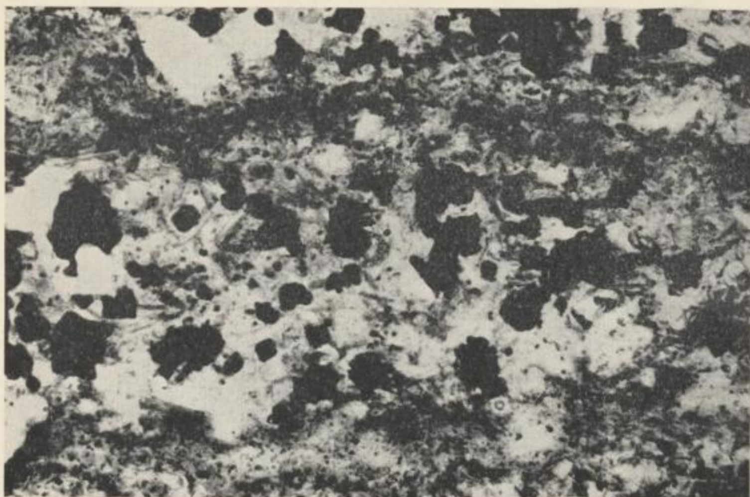
Bild 50. Unterer Metallhorizont, T3; Sulfide (schwarz) in groben, sandigen Lagen des Schiefertons; Bucht von Frohburg-Geithain; Aufschlußpunkt 78; // Nic., Vergr. 60 ×
