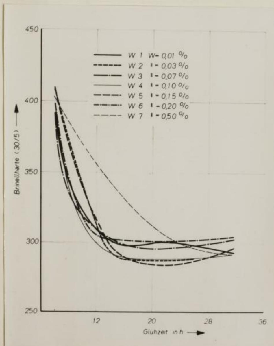
Abb. 37 Abhängigkeit der Härte von der Temperzeit bei verschiedenen Wolframzusätzen
