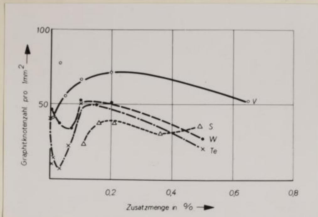
Abb. 36 Abhängigkeit der Graphitknotenzahl von der Zusatzmenge bei verschiedenen Elementen
