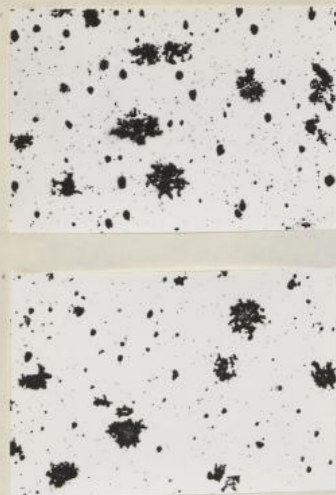
Abb. 70 Die Form der Temperkohle bei verschiedenen Zinksusätzen, Glüh Temperatur 980^{\circ} C, 100:1 a) 0,02 % Zn, Glühdauer 24 h b) 0,06 % Zn, Glühdauer 18 h c) 0,10 % Zn, Glühdauer 12 h d) 0,20 % Zn, Glühdauer 18 h e) 0,30 % Zn, Glühdauer 12 h f) 0,50 % Zn, Glühdauer 12 h
