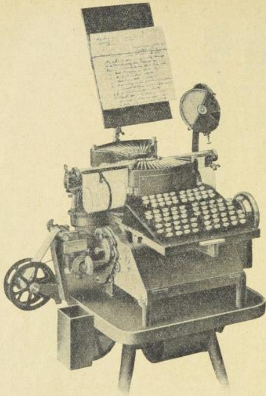
Setzapparat des Elektro-Typographen von Méray und Rozar. Diese Maschine hat trotz vieler Mühen der Erbauer in der Praxis nicht Eingang finden können
