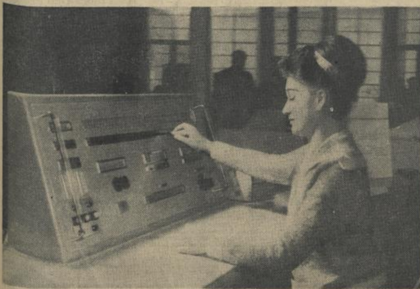
Während der Messe stand dieser Zeit-Rechenautomat ZKA 1, von dem unser Foto das Steuerpult zeigt, nach im Zeiß-Pavillon. Binnen kurzem wird er das Herz des neugebildeten Rechenzentrums der Karl-Marx-Universität sein. Foto: HFB
