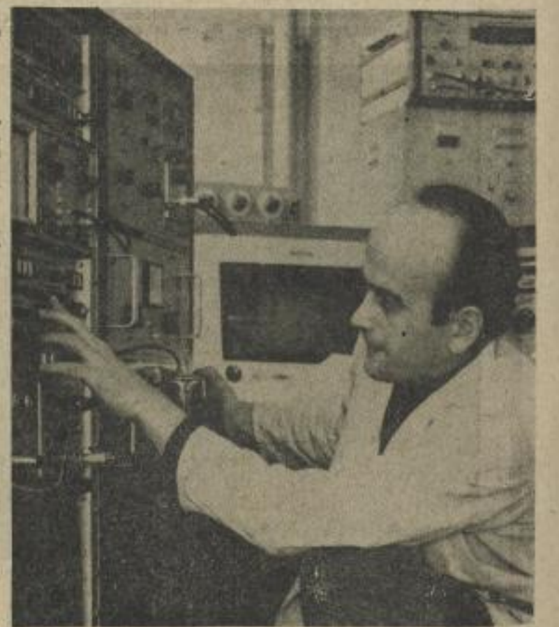
AN DER SEKTION PHYSIK - ein Kernresonanzspektrometer, das zum Bestandteil der täglichen Arbeit zählt.
