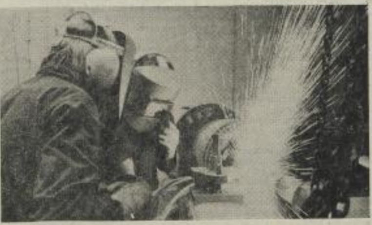
Um mehr als die Hälfte wird die zum Regenerieren der Läuferrollen von Antriebmotoren benötigte Arbeitszeit durch ein von Arbeitern und Konstrukteuren des Erfurter Reparaturwerkes „Clara Zetkin“ entwickeltes Verfahren gesenkt. Foto: ADN-ZB/Kasper
